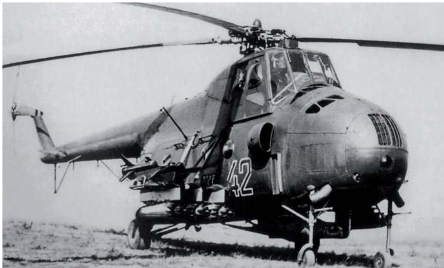
▲ Mi-4AW, uzbrojony w ppk Falanga i wyrzutnie UB-16-57 dla npr S-5 kal. 57 mm. Takie śmigłowce przechodziły próby w latach 1965–1967 w 12. Samodzielnej Doświadczalnej Eskadrze Śmigłowców (Woroszyłowgrad).
