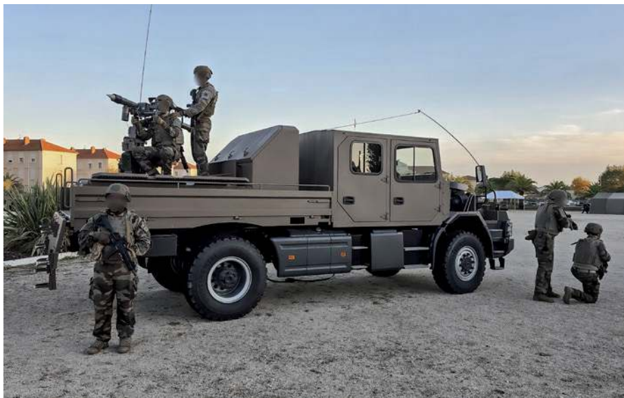
▲ Zestaw PAMELA z wyrzutnią pocisków Mistral był już stosowany we francuskiej armii. Nowa jego odsłona oznaczała poprawę mobilności poprzez zmianę podwozia na Vampire .
