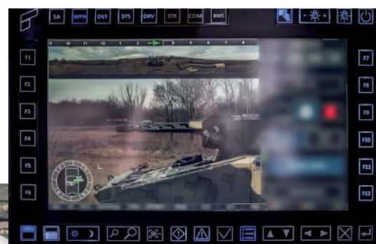
◀ Stanowisko działonowego w wieży KF-41 (symulator), w tym widoczne jego rękojeści do sterowania. Powyżej obraz także z kamery CCD działonowego, wraz z pulpitem i wieńcem przycisków dotykowych.
