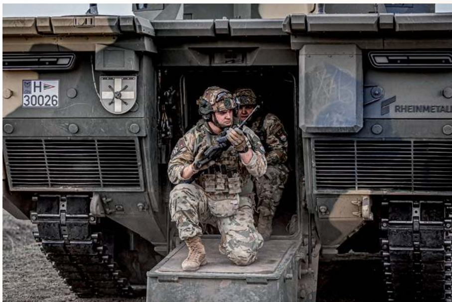
▲ Tył kadłuba i opuszczana rampa umożliwiającą działanie piechoty w oparciu o przedział desantowy, w którym mieścić się ma ośmiu żołnierzy.
