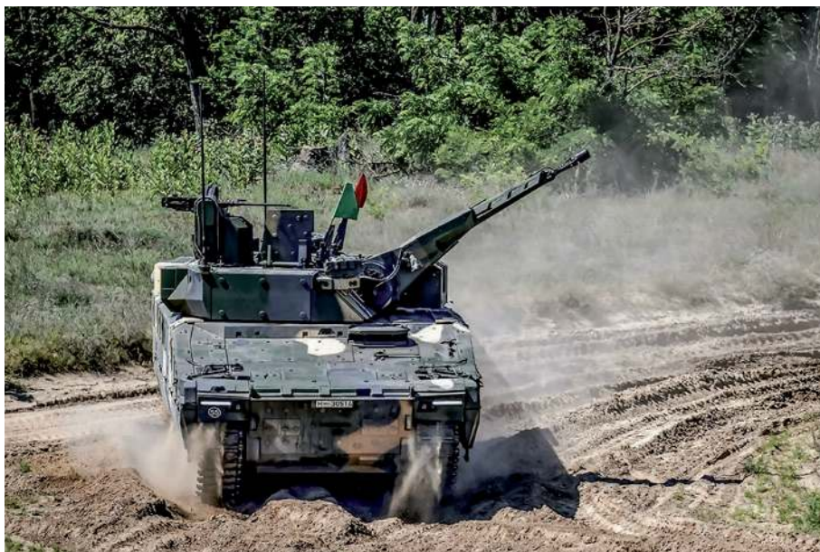
▲ Armata MK 30-2/ABM w górnym położeniu około 45 stopni. Możliwości podniesienia działka pozwalają na rażenie wyższych pięter budynków, ostrzał w terenie górskim, ale i obronę przed zagrożeniami pojawiającymi się ze strony uzbrojenia lotniczego i statków powietrznych.
