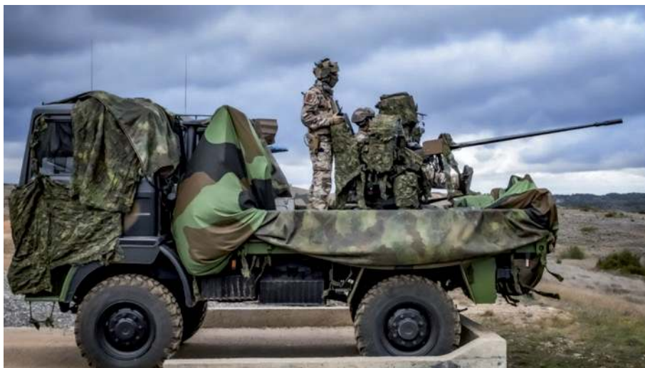
▲ PROTEUS Standard 1 nadal wykorzystuje starsze podwozia TRM 2000, ale docelowo znaleźć się ma również na Scania Vampire, przede wszystkim w odmianie Standard 2.
