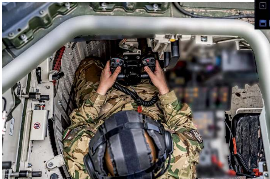
◀ Stanowisko działonowego w wieży KF-41 (symulator), w tym widoczne jego rękojeści do sterowania. Powyżej obraz także z kamery CCD działonowego, wraz z pulpitem i wieńcem przycisków dotykowych.
