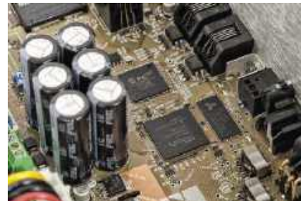
Ayre zaprojektowało własne algorytmy filtrów, realizowane są przez nowoczesne procesory FPGA.
