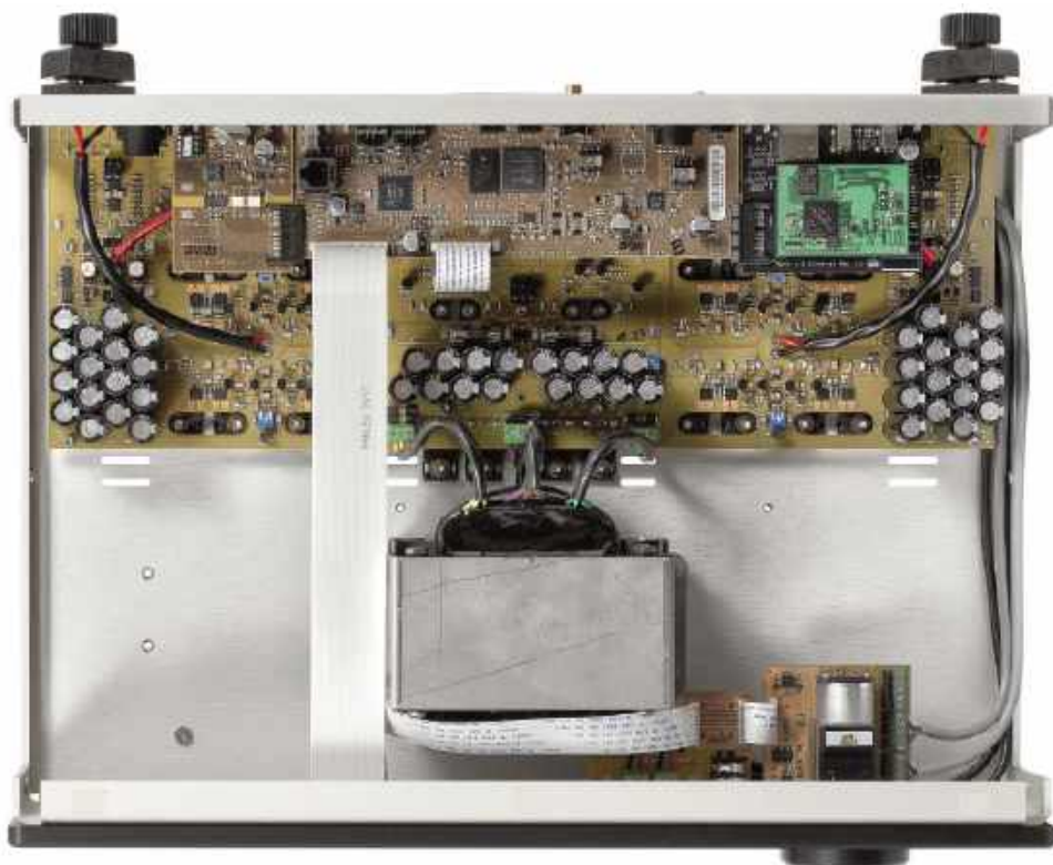
Niemal cała elektronika zmieściła się w tylnej części obudowy. Brak widocznego radiatora nie oznacza, że EX-8 jest konstrukcją impulsową; rolę radiatora pełni dolna część obudowy.
