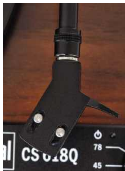
Okazałe zawieszenie złożone jest z dwóch pierścieni oraz masywnej obejm.
