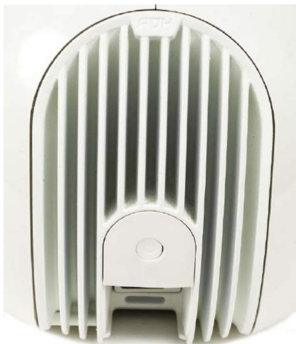
Z tyłu zainstalowano panel z radiatorami końcówek mocy i gniazdami przyłączeniowymi.
