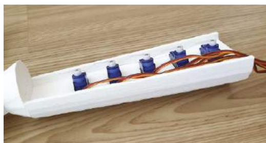
3. Wydrukowane przedramię z zamontowanymi serwomechanizmami
