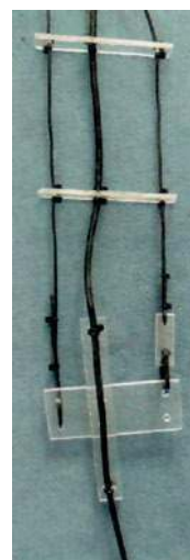
Rozpórki z płytek akrylowych
