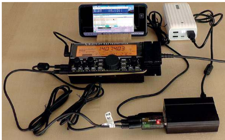
Kompletne wyposażenie do pracy terenowej. Oprócz radiostacji KX2 składają się na nie modem FT8-Box, telefon androidowy i akumulator 5 V. FT8 jest emisją o stałej obwiedni dlatego też radiostacja ma dodatkowy radiator zapobiegający jej przegrzaniu
