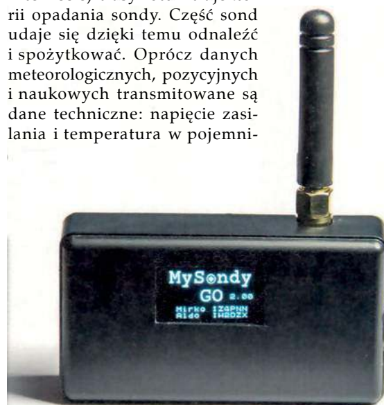
Odbiornik z modulem LoRa dostosowany do odbioru sond
