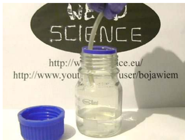
Fot. 4 – Wprowadzanie gazowego chloru ponad powierzchnię roztworu
