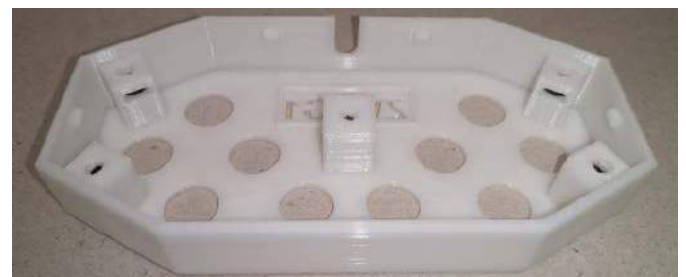
Fotografia 4. Pogłębienie otworów montażowych i umiejscowienie nakrętek M3
