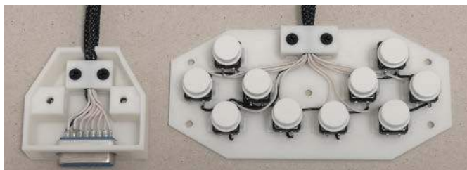
Fotografia 2. Wykonane połączenia pomiędzy przyciskami w kontrolerze i złączem D-SUB15
