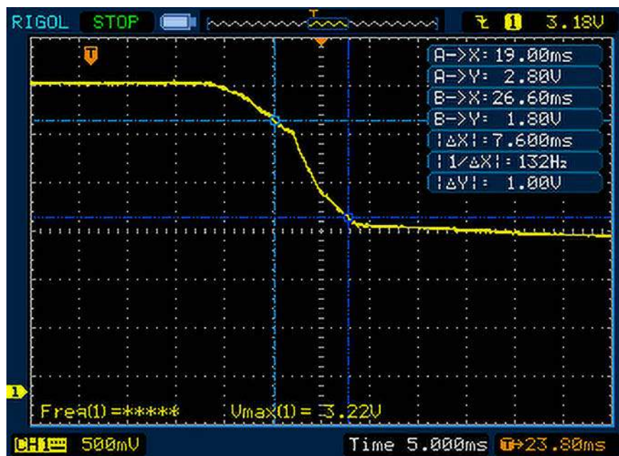
Rysunek 2. Wykres zależności napięcia zasilania mikrokontrolera w funkcji czasu podczas wyłączania urządzenia
