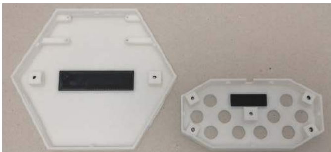
Fotografia 5. Wklejenie czarnych zaślepek w górnej części bazy oraz kontrolera
