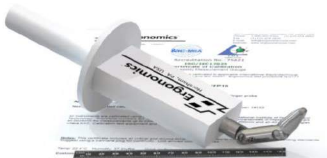
Fotografia 21. Znormalizowany palec probierczy zgodny z normą 60601-1 ( https://t.ly/9FO4 )
