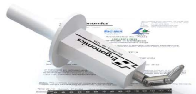
Fotografia 21. Znormalizowany palec probierczy zgodny z normą 60601-1 ( https://t.ly/9FO4 )
