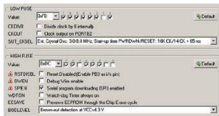
Rysunek 3. Szczegóły ustawienia bitów zabezpieczających
