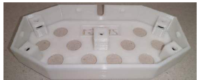
Fotografia 4. Pogłębienie otworów montażowych i umiejscowienie nakrętek M3
