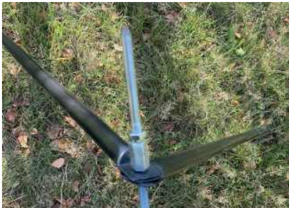
Na końcówki nóg statywu nakładamy poprzeczki usztywniające i przykręcamy groty
