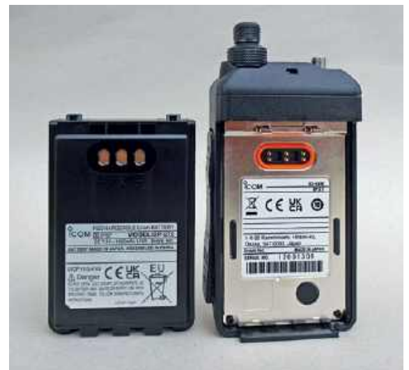
Akumulator BP-272 o pojemności 1880 mAh zapewnia długi czas pracy
