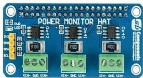
Rys. 5.. Moduł przetworników ADC produkcji SB Components
