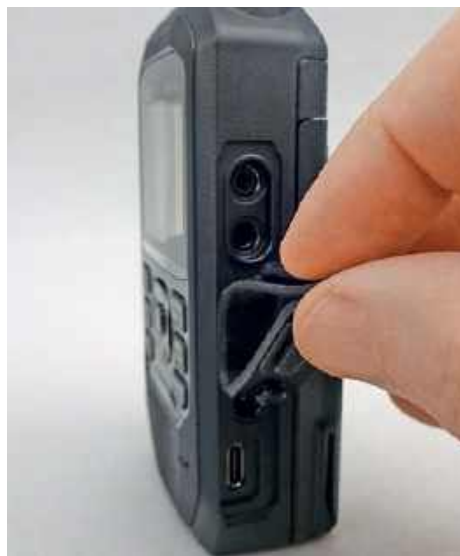
Gniazda połączeniowe są ukryte pod osłonami
