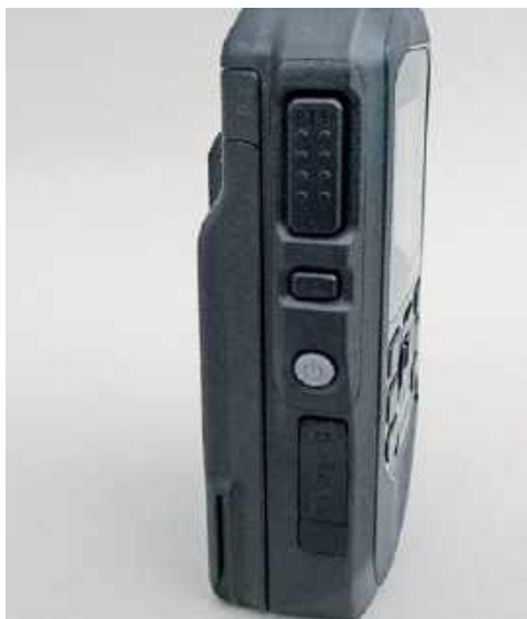
Wglębione przyciski z wyraźnym punktem nacisku zapobiegają błędom w obsłudze
