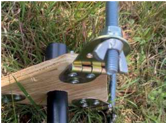
Przykręcamy pręty nakrętkami motylkowymi do zawiasów w płycie statywu
