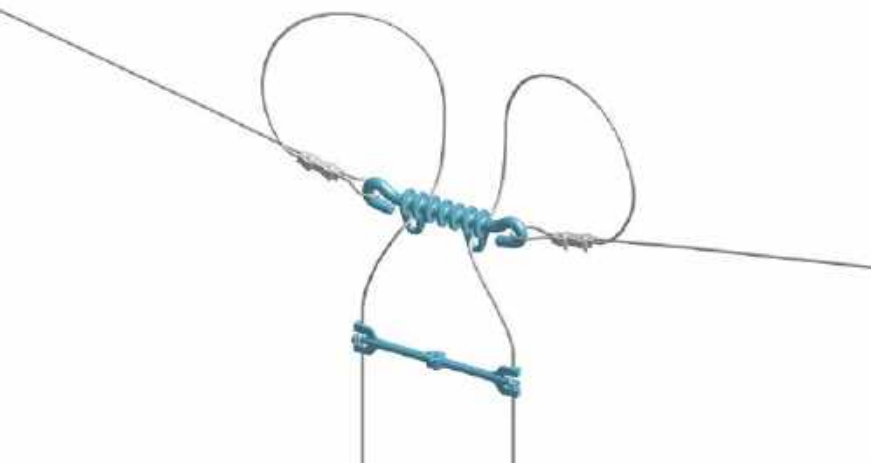
Rys. 9. Izolator środkowy elementu prostego i rozpórka linii drabinkowej
