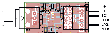
Rysunek 2. Schemat płytki PCB z rozmieszczeniem elementów na stronie TOP
