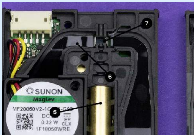
Rysunek 3. Laser i czujnik światłoczuły [6]
