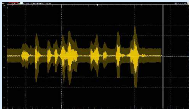
Rysunek 2. Napięcia na wejściu ADC przy rejestracji mowy
