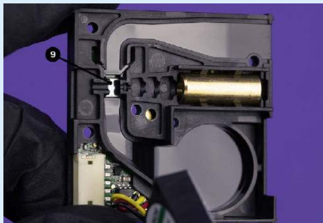
Rysunek 6. Kanał przepływu powietrza mierzonego [6]
