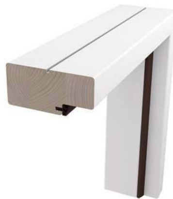
➤ Ościeżnice stałe najlepiej sprawdzają się w przypadku ścian o grubości 6–10 cm. Wymagają zastosowania listew maskujących (opasek) przytwierdzanych za pomocą kleju montażowego. Szczelinę między opaską a ścianą wypełnia się masą akrylową. POL-SKONE
