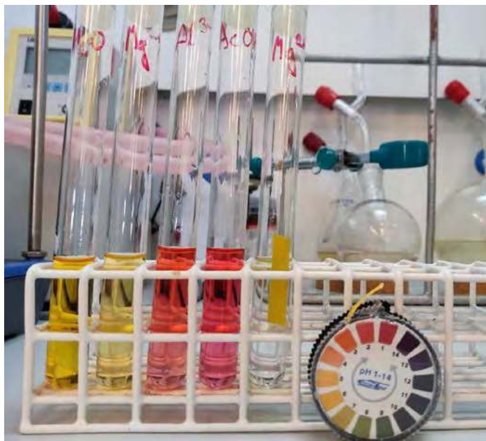
Fot. 1. Barwy wskaźników w roztworach różnych soli: oranżu metylowego wobec wody (pierwsza z lewej), a dalej wobec roztworów o stężeniu 0,2 mol/dm 3 : MgSO 4 , KAl(SO 4 ) 2 , CH 3 COOH. Ostatnia z prawej: uniwersalny papierek wskaźnikowy w roztworze MgSO 4 o stężeniu 0,2 mol/dm 3 . Przygotowanie roztworów do tego doświadczenia opisane jest na końcu artykułu.
