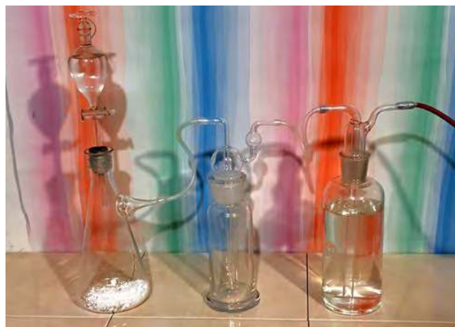
Fot. 10 – Układ doświadczalny zestawiony według schematu z rys. 1 – przed waniem wody amoniakalnej do środkowego naczynia
