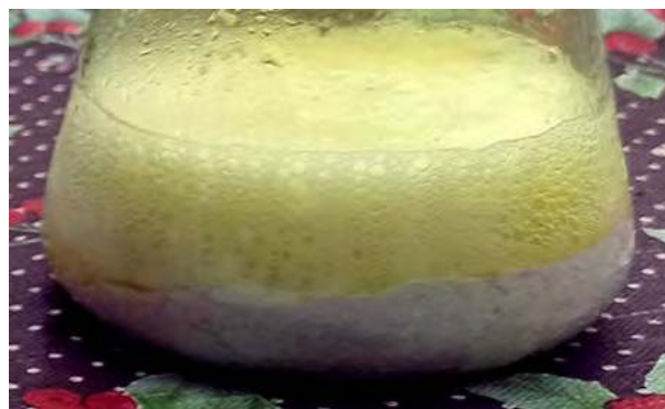
Fot. 5 – Reakcja chloranu(I) wapnia z kwasem chlorowodorowym, w wyniku której powstaje m.in. gazowy chlor
