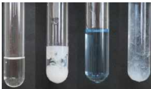
6. Wykrywanie jonów srebra (kolejne etapy od lewej). Do bezbarwnego roztworu zawierającego jony srebra dodajemy roztwór kwasu solnego, co powoduje wytrącenie białego osadu. Po dodaniu roztworu amoniaku osad rozpuszcza się. Dodatek roztworu kwasu azotowego(V) powoduje ponowne wytrącenie osadu.
