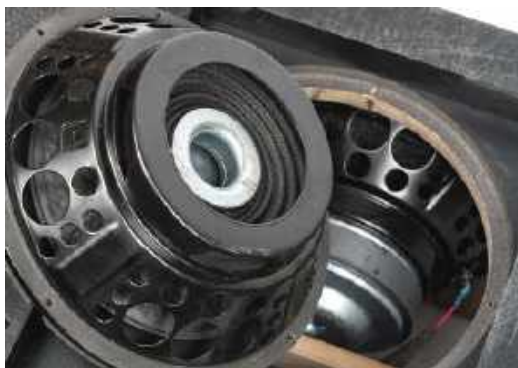
Membrana biała jest dociążona pierścieniem dotychczas tam, gdzie w normalnym głośniku znajduje się cewka
