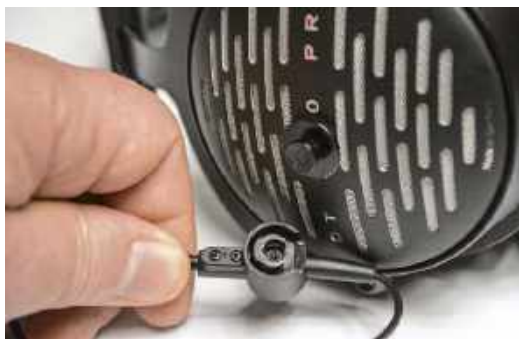
Widelcowy uchwyt wysięgnika mikrofonu pozwala skokową na regulację kąta jego odchylenia.
