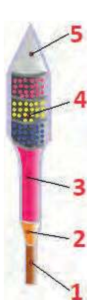
Rysunek 1. Konstrukcja fajerwerku: 1 – kij („ogon”), 2 – zapalnik, 3 – ładunek wybuchowy, 4 – wypełnienie zapewniające atrakcyjne efekty wizualne, 5 – „głowa”.
