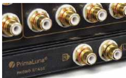
Jest opcja zainstalowania modułu korekcji gramofonowej, który przykręca się do dolnej ścianki.
