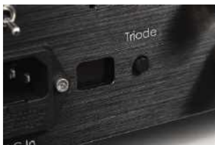
Przełącznik trybów pracy końcówki mocy (trioda/pentoda) pozwala zmieniać nie tylko moc, ale przede wszystkim brzmienie.
