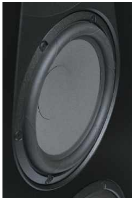
Głośnik 15-cm, podejrzewany o występowanie w roli nisko-średniotonowego w układzie dwuipółdrożnym, w rzeczywistości pracuje jako średniotonowy.
