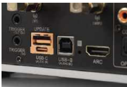
W sekcji cyfrowej znajdują się dwa wejścia USB i HDMI z kanałem zwrotnym ARC.
