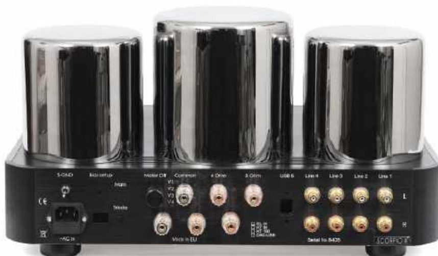
Wyjścia głośnikowe przygotowano klasycznie, z dwoma parami odczepów dla obciążeń 8 i 4 Ω.
