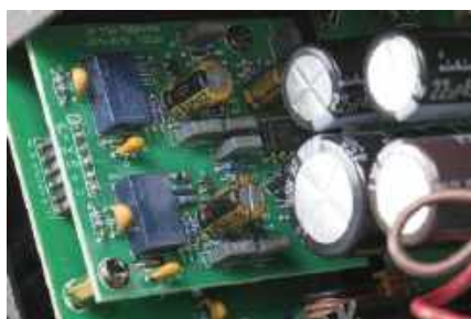
Wejścia znajdują się na oddzielnym module, sekcja przedwzmacniacza gramofonowego jest półprzewodnikowa.
