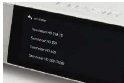
Korekcja HP-EQ dopasowuje charakterystykę przetwarzania do tzw. krzywej Harmana. Na pewno warto spróbować.
