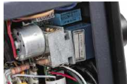
Wśród kilku klasycznych rozwiązań ponownie potencjometr Alpsa, oczywiście w roli regulatora głośności.
