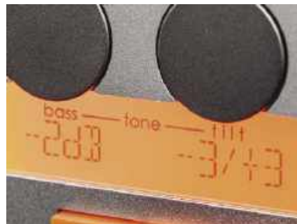
Ciekawostką są nietypowe korekcie charakterystyki (firmowy układ Tilt).
