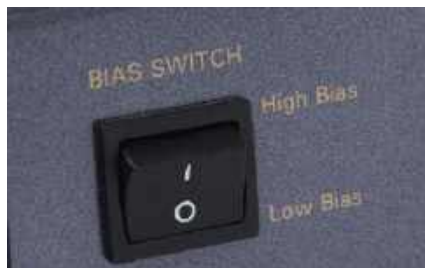
Wśród nietypowych rozwiązań jest możliwość zmiany lamp w końcówce mocy; większym KT88 należy się specjalny tryb pracy.
