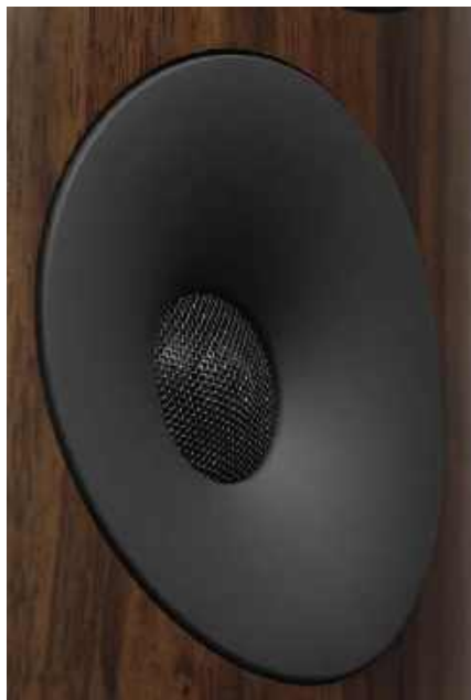
Wyprofilowanie wokół wysokotonowego konieczne, aby wyprowadzić powierzchnię do krawędzi otworu w wygiętym froncie, tworzy jednocześnie falowod regulujący charakterystyki kierunkowe.
