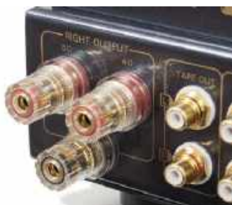
Wyjścia głośnikowe to dwie pary odczepów skalibrowane dla obciążeń nominalnie 4 i 8 Ω.
