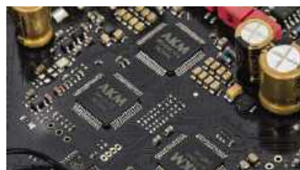
Sekcję cyfrową tworzą tym razem referencyjne układy AKM.
