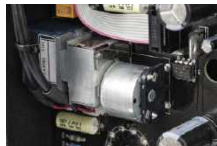
Układ na głównej płycie audio zaczyna się od regulacji głośności, czyli ponownie od potencjometru Alpsa.
