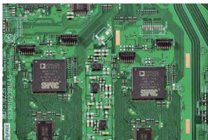
Obsługę sygnałów audio powierzono dwóm procesorom DSP Analog Devices SHARC.
