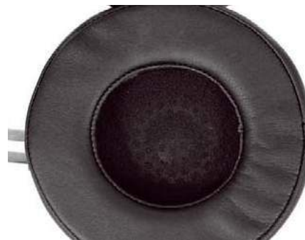
Przetworniki mają znaczną średnicę (53 mm), w głębi widać metalowe dyfuzory i tekstylne siateczki.
