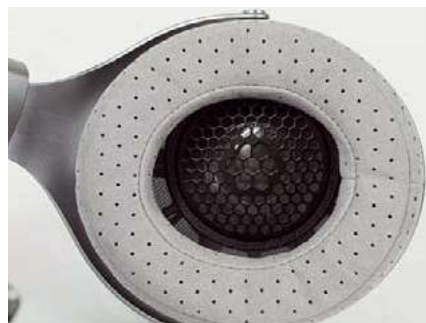
Sporo tu nawiązań do referencyjnej Utopii, membrany mają profil „M”, chociaż są wykonane z innego materiału (aluminium-magnez zamiast berylu).
