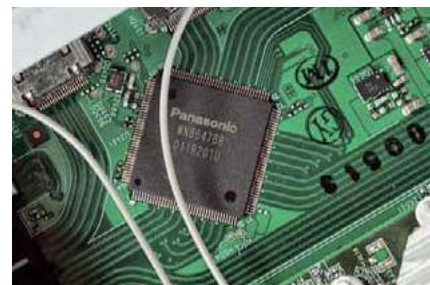
W większości amplitunerów sygnały z gniazd HDMI trafiają do skalaków firmy Panasonic; w tym przypadku zajęły się one również formatem 8K.
