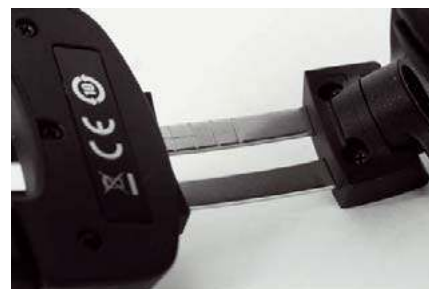
Podstawową regulację uzupełniono mechanizmem zapadkowym; słuchawki dobrze trzymają się głowy.
