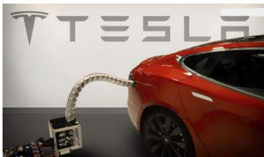
4. Imitujący słoniową trąbę zrobotyzowany przewód ładujący Tesli
