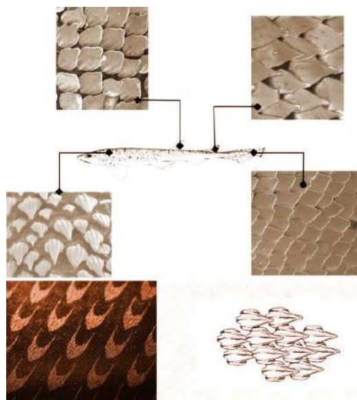
4. Struktura skóry rekinka psiego i materiał Speedo FastSkin
