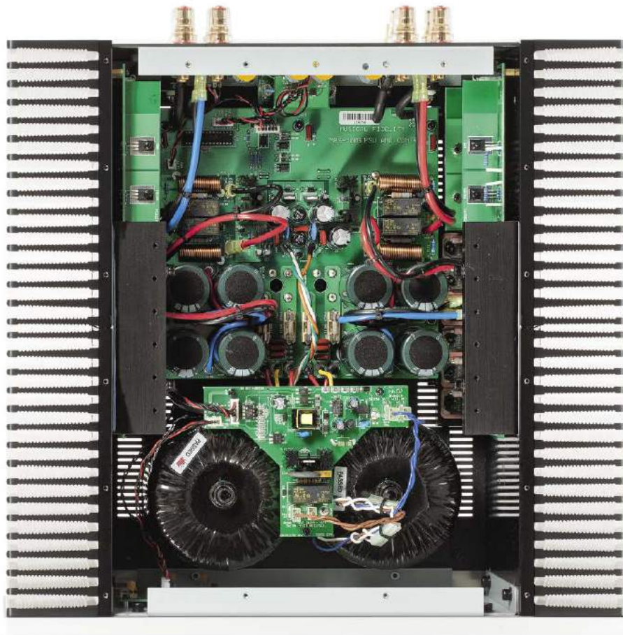
Niezależne zasilacze obydwu końcówek zapewniają utrzymanie pełnej mocy przy jednoczesnymysterowaniu obydwu kanałów.
