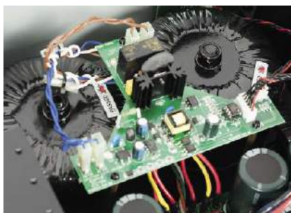
Niezależne zasilacze obydwu końcówek zapewniają utrzymanie pełnej mocy przy jednoczesnymysterowaniu obydwu kanałów.
