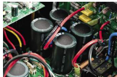
Niezależne zasilacze obydwu końcówek zapewniają utrzymanie pełnej mocy przy jednoczesnymysterowaniu obydwu kanałów.
