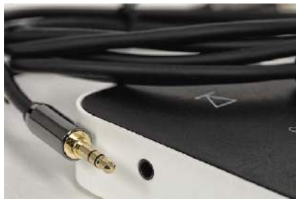
Gniazdo 3,5 mm to zarówno typowe wyjście analogowe, jak i cyfrowe złącze optyczne.
