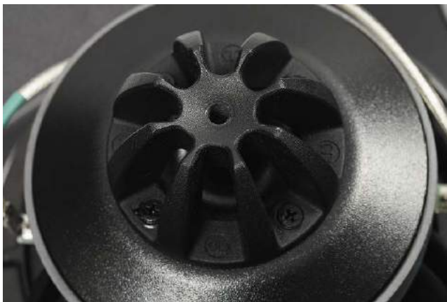
Za układem magnetycznym znajduje się radiator, w centrum którego przygotowano gwint dla śruby mocującej.
