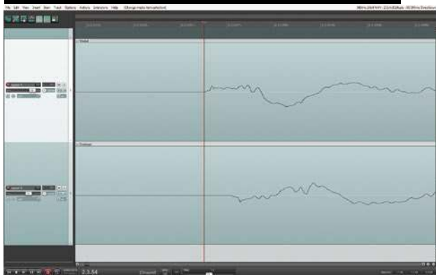
Rys. 3 – odwrócenie polaryzacji, niwelujące przeciwfazę.
