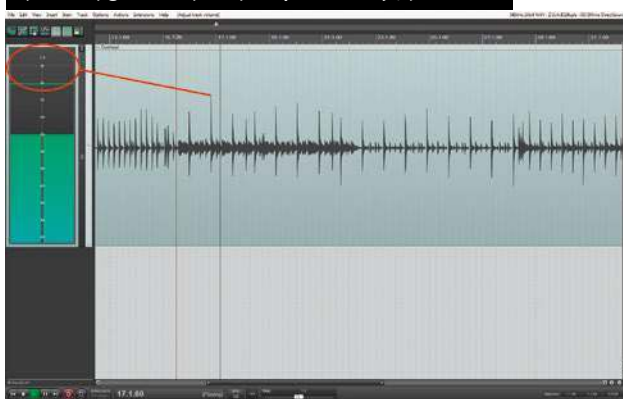
Rys. 2 – niezgodność fazowa, wynikająca z różnic czasowych, powodowanych dystansem od źródła dźwięku.
