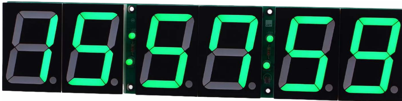
Fotografia 1. Zegar z zielonym wyświetlaczem 55 mm (zestaw AVT5522/2/G)
