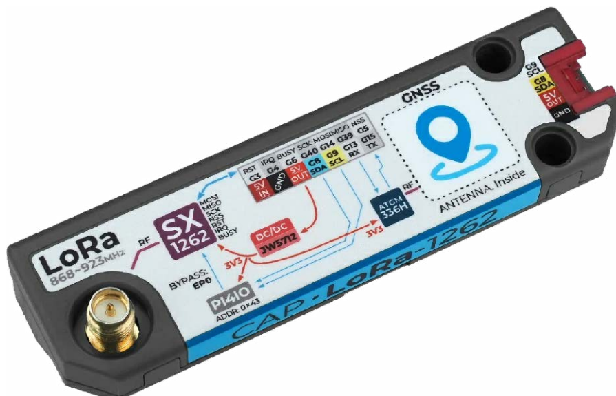
Fotografia 3. Moduł LoRa-1262 ma również ilustrację opisującą jego budowę
