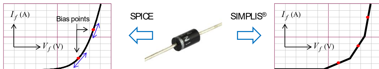
Rysunek 12. SIMPLIS posługuje się elementami idealnymi opisanymi odcinkami liniowymi
