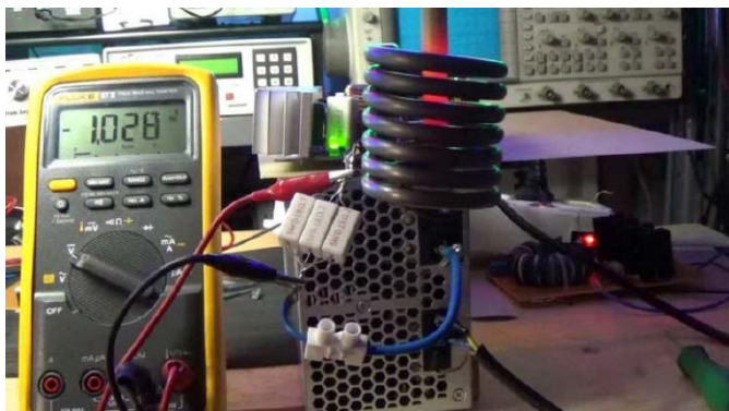
Rysunek 9. Pomiar prądu pobieranego przez układ na podstawie spadku napięcia na boczniku
