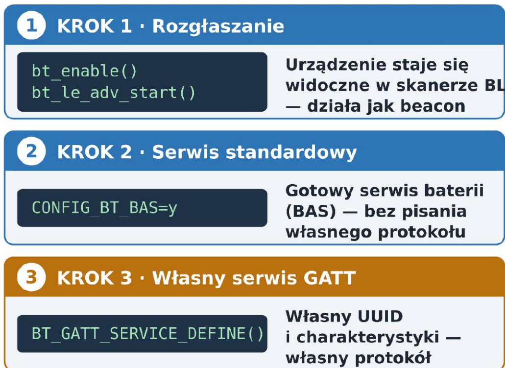
Rysunek 6. Budowa peryferium BLE w trzech krokach. Trudność i zakres kontroli nad protokołem rosną z każdym krokiem – od prostego rozgłaszania po własny serwis GATT
