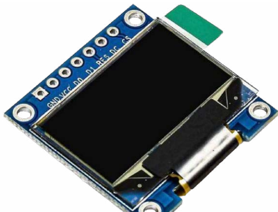
Rysunek 2. Żółto-niebieski wyświetlacz OLED SPI 0,96" o rozdzielczości 128×64
