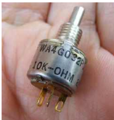
Rysunek 37. Seria W firmy Allen-Bradley to niewielkie, szczelne i bardzo ciche potencjometry.
