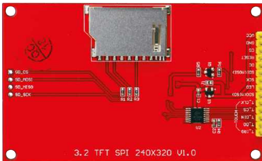
Rysunek 4. Tak powinien wyglądać wyświetlacz LCD przeznaczony do Pico Gamera. Wyświetlacze tego typu można kupić na eBayu i AliExpress. Przed zakupem należy jednak sprawdzić, czy zdjęcie zamieszczone przez sprzedawcę odpowiada przedstawionemu wyżej wyświetlaczowi. Niektóre wersje różnią się konstrukcją i nie będą pasować do tej płytki drukowanej. W górnej części naszego wyświetlacza, wzdłuż panelu dotykowego, znajduje się napis „HR4 8637S G6/2”.
