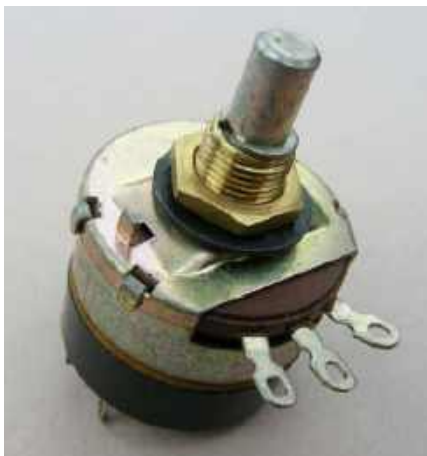
Rysunek 45. Klasyczny potencjometr przemysłowy serii Plessey E ze ścieżką węglową formowaną na gorąco jest niemal niezniszczalny.
