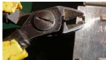
Rysunek 26. Demontaż potencjometru suwakowego Alps w celu jego wyczyszczenia. Ściśnij zatraski, aby zdjąć boczną osłonę.
