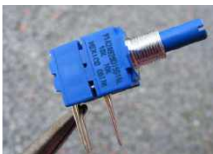
Rysunek 41. Potencjometr Bourns 91 to mój ulubiony regulator głośności. Jego plastikowa obudowa nie jest zbyt solidna, ale pod względem poziomu szumów nie ma sobie równych. Jest dostępny w firmach Farnell i Audio Out.
