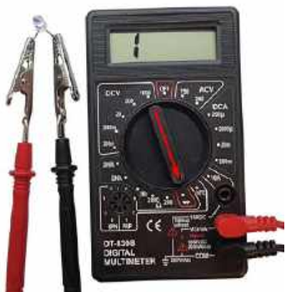
Fotografia 4. Sprawdzanie diody LED za pomocą multimetru ustawionego na funkcję testowania diod. Po przyłożeniu sondy czerwonej do anody, a czarnej do katody, sprawna dioda LED powinna się zaświecić. Jeśli dioda ma odpowiednio długie (jeszcze nie przycięte) wyprowadzenia można się wspomóc krokodylkami
