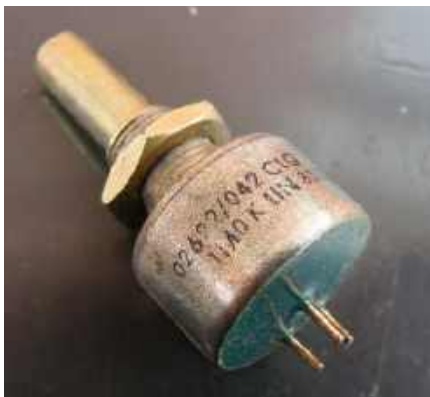
Rysunek 43. Potencjometr Citec/Plessey CLQ ze ścieżką węglową formowaną na gorąco jest stosowany w lotnictwie. Jest bardzo drogi, ale również bardzo wytrzymały. Istnieje także wersja cermetowa MCU/1, która nie nadaje się do regulatorów głośności.
