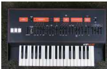
Rysunek 25. Piękny syntezator z zatartymi potencjometrami suwakowymi, zastosowanymi wyłącznie ze względów stylistycznych. Naprawa będzie kosztowała około 200 funtów. W tym przypadku warto ponieść ten wydatek, ponieważ jest to kolekcjonerski model firmy ARP.
