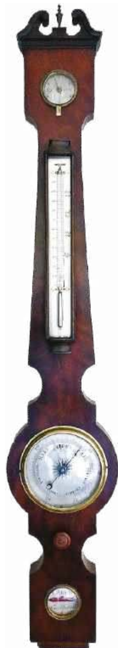
Rysunek 11.1. Barometr rtęciowy autora, umieszczony w mahoniowej obudowie z okresu późnej regencji. Przyrząd zawiera dużą, okrągłą posrebrzaną tarczę barometru, termometr rtęciowy (długi prostokątny wskaźnik), higrometr (okrągła tarcza u góry) oraz poziomnicę spirytusową z czerwonym alkoholem, umieszczoną na dole.
