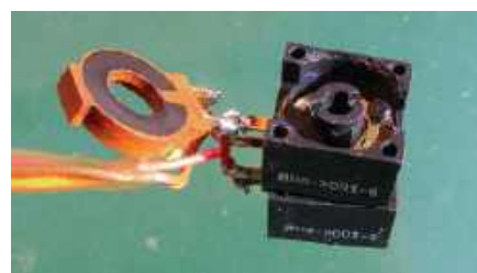
Rysunek 21. Po niewielkim podpiwowaniu plastikowej ramki z potencjometru ModPot można wyjąć zespół prowadnicy ze ścieżką oporową, aby ją wyczyścić i wypolerować. Dzięki temu potencjometr może bezproblemowo pracować przez kolejne dziesięć lat.
