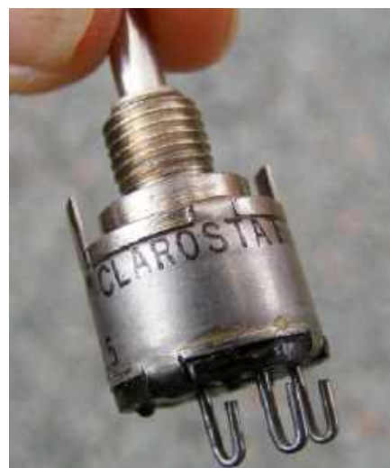
Rysunek 42. Clarostat RV6 to niewielki potencjometr ze ścieżką z tworzywa przewodzącego, wykonany zgodnie ze specyfikacją wojskową i zamknięty w szczelnej obudowie ze stali nierdzewnej. Przez wiele lat stosowałem go jako regulator strojenia w moim Pocket Thereminie.
