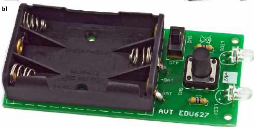
Fotografia 2. Zestaw do budowy podręcznej latarki LED (kod AVTEDU627); a) zestaw do samodzielnego złożenia; b) zmontowany układ
