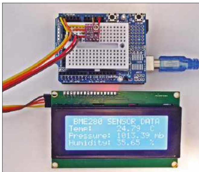
Rysunek 11.5. Dane z czujnika BME280 wyświetlane na znakowym wyświetlaczu LCD 20×4 z interfejsem I²C.
