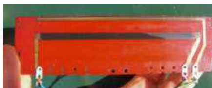
Rysunek 28. Dokładnie wyczyszczony suwak, gotowy do usunięcia śladów korozji i nałożenia smaru.
