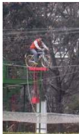
Rys. 1. (a) „Miś ekwilibrysta” jako najprostszy przykład zagadnienia równowagi. Może on zostać przybliżony przez trzy masy punktowe (dwie kulki i korpus misia) a środek ciężkości tego układu mas jest pod punktem podparcia. (b) Rowerzysta ze sklepu przy Muzeum w Berlinie jest jeszcze prostszy: tylko dwie masy, a ich środki ciężkości są pod punktem podparcia. (c) Ten sam „eksponat” w skali makro: jazda rowerem na linie (z dużym obciążnikiem na długim ramieniu pod liną), Turyn, Parco Michelotti, wystawa Experimenta 06, foto Maria Karwasz, 2006.
