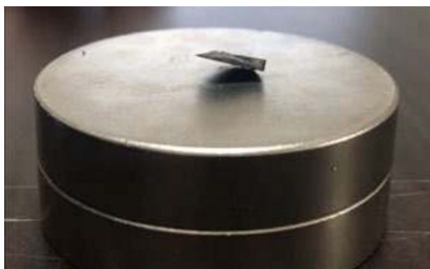
Rys. 5. Chłodzony ciekłym azotem magnes lewitujący nad nadprzewodnikiem wysokotemperaturowym, źródło: [7].
