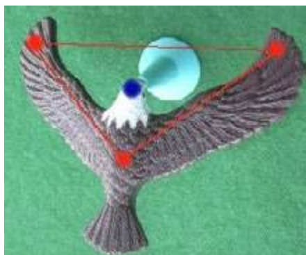
Rys. 4. (a) Układ trzech punktowych mas: udajemy na tym rysunku, że są one identyczne, a niebieski punkt postawiliśmy w punkcie podparcia. (b) Ten eksponat może służyć również na lekcji matematyki: środek ciężkości trójkąta (pełnego, czyli wyciętego np. z kartonu) jest na przecięciu trzech środkowych. Źródło: www.andreamini.org . (c) Układ skrzydeł zapewnia warunek „miśka”: środek ciężkości całości jest pod punktem podparcia. Foto: Andrzej Krzysztofowicz.
