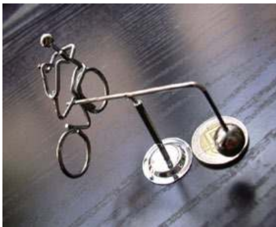
Rys. 1. (a) „Miś ekwilibrysta” jako najprostszy przykład zagadnienia równowagi. Może on zostać przybliżony przez trzy masy punktowe (dwie kulki i korpus misia) a środek ciężkości tego układu mas jest pod punktem podparcia. (b) Rowerzysta ze sklepu przy Muzeum w Berlinie jest jeszcze prostszy: tylko dwie masy, a ich środki ciężkości są pod punktem podparcia. (c) Ten sam „eksponat” w skali makro: jazda rowerem na linie (z dużym obciążnikiem na długim ramieniu pod liną), Turyn, Parco Michelotti, wystawa Experimenta 06, foto Maria Karwasz, 2006.
