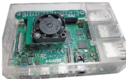
Fotografia 1. Zamontowany wentylator na Raspberry Pi 4B
