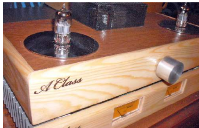
Fotografia 6. Napis na drewnie wykonany metodą termotransferową (źródło: majsterkowo.pl)
