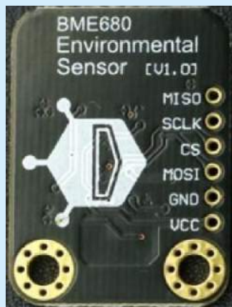
Rysunek 6. Płytka BME680 Environmental Sensor (widok z dołu) [7]
