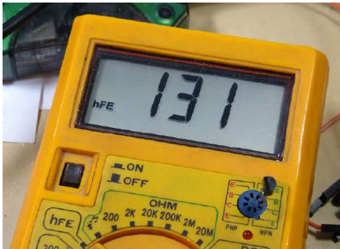
Fotografia 1. Pomiar parametru hFE tranzystora 2N3904 miernikiem Metex
