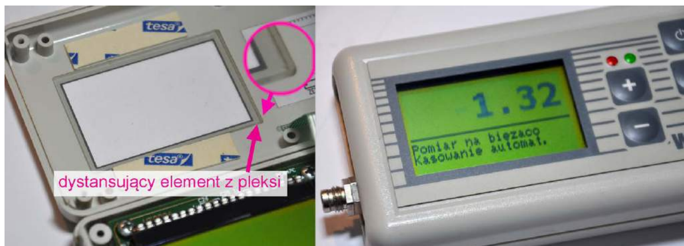
Fotografia 7. Płytkę dystansującą z pleksi nad wyświetlaczem na klawiaturze foliowej
