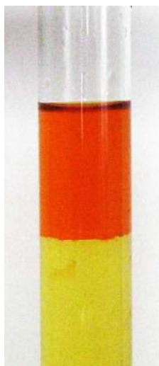
3. Brom wyekstrahowany z warstwy wodnej (dolna) zabarwia na czerwono-brunatno warstwę rozpuszczalnika organicznego (górną).
