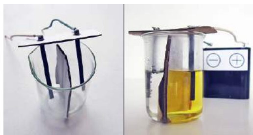
4. Domowej roboty elektrolizer przeponowy po lewej i ten sam elektrolizer podczas produkcji wody bromowej (po prawej). Odczynnik powstaje wokół elektrody dodatniej; na elektrodzie ujemnej widoczne są pęcherzyki wodoru.
