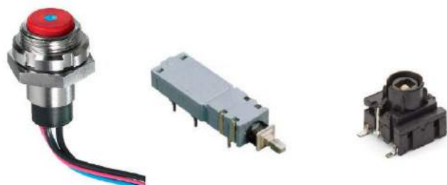
Fotografia 4. Łączniki o różnym sposobie montażu (od lewej): panelowy, THT i SMD, firmy APEM
