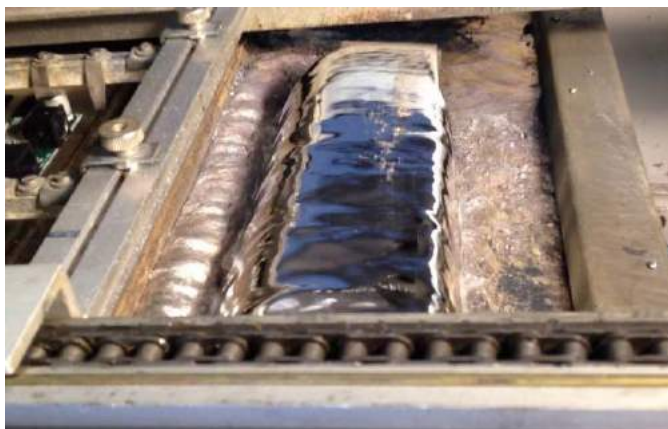
Fotografia 9. Strumień roztopionego spoiwa do lutowania na fali
