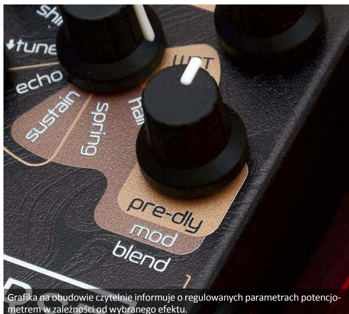
Dolna gałka po lewej stronie odpowiada za zmianę barwy pogłosu, utrzymania wybrzmienia w trybie Sustain lub regulację czasu odbić delay'a w trybie Echo.
