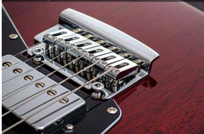
Mostek Fulcrum Tremolo zakotwiczony jest na dwóch śrubach wkręconych w tuleje umieszczone w korpusie.
