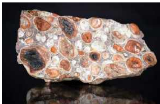
1. Niepozorny, gliniastej barwy minerał to surowiec do produkcji aluminium (źródło: United States Geological Survey, https://www.usgs.gov )
