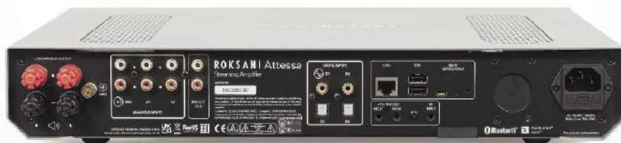
Na tylnej ścianie widać podział na sekcję cyfrową i analogową.
