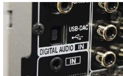
W panelu cyfrowym są ważni i ważniejsi, a liderem jest oczywiście wejście USB przyjmujące sygnały PCM 32/384 oraz DSD256.
