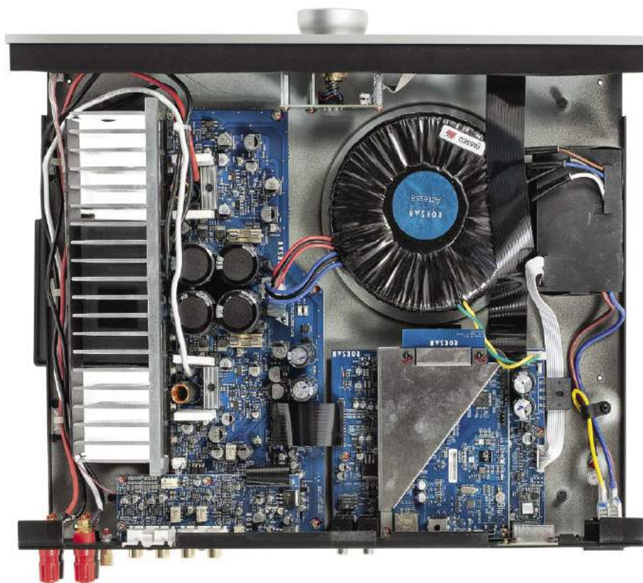
Wygląda jak klasyczny brytyjski wzmacniacz analogowy... z cyfrowymi dodatkami. Duży transformator toroidalny głównie dla końcówek mocy, mniejszy zasilacz impulsowy dla sekcji cyfrowej.
