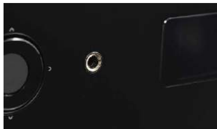
Gniazdo słuchawkowe (6,3 mm) jest podłączone do niezależnego (od głównych końcówek) układu wzmacniającego.
