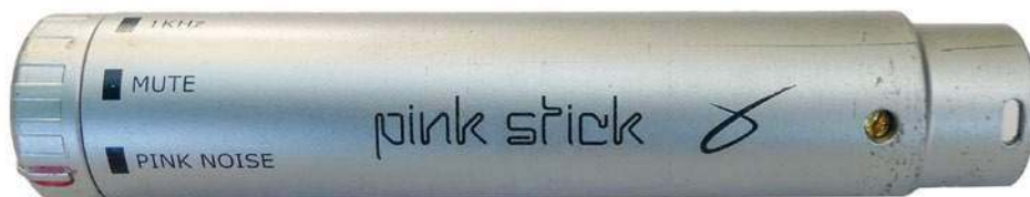
Źródłem sygnału szumu różowego jest urządzenie o nazwie Pink-Stick, wpięte w kanał miksera.
