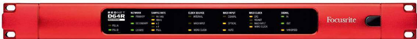
Użytkowników konsol pracujących z sygnałami MADI zainteresować może RedNet D64R, który obsługuje do 64-kanalów MADI.
