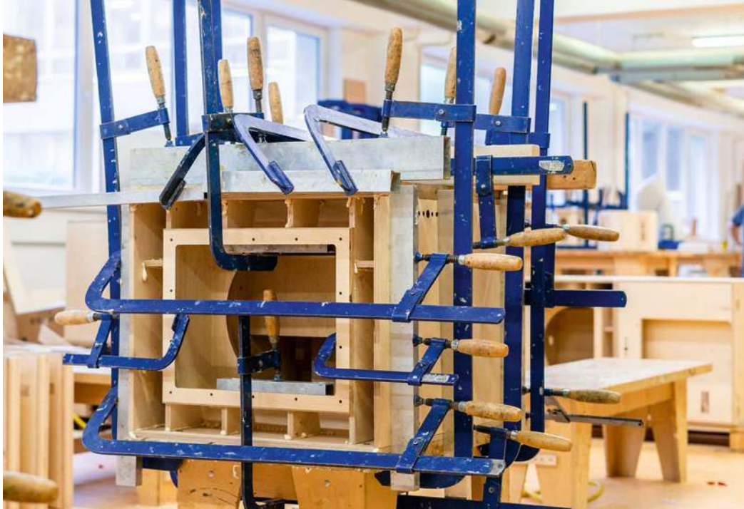
Każda część obudowy po wycięciu przez maszynę jest przygotowywana do klejenia i skręcania.
