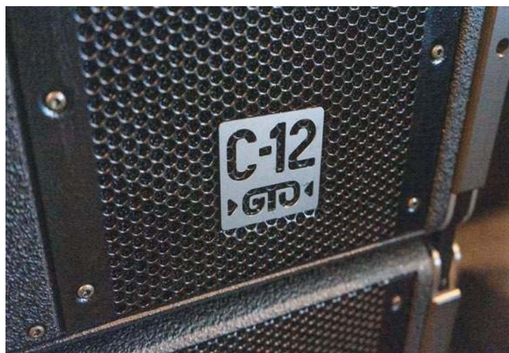
C-12 to bardziej kompaktowy i lżejszy od starszych braci moduł, zbudowany w oparciu o „tylko” 8 przetworników.
