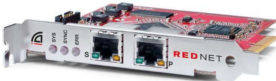
Za pomocą karty RedNet PCIeR można połączyć sieć RedNet z komputerem – to jeden z trzech sposobów, w jaki można to zrobić.
