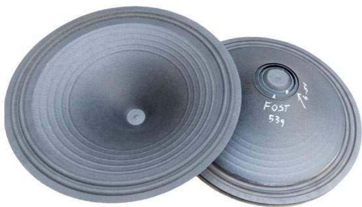
Membrana 15" wykonana w celu regeneracji większej partii głośników Fostex.
