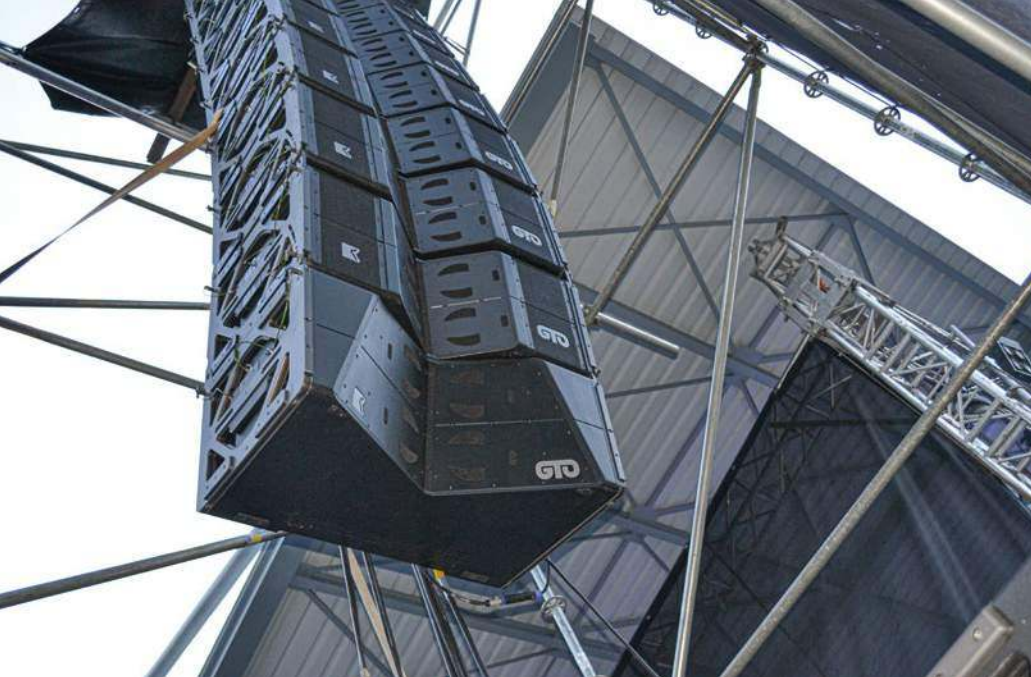
GTO-DF oferuje 120-stopniową dyspersję w poziomie, nie ma natomiast głośników 15-calowych i ma tylko dwa driversy.
