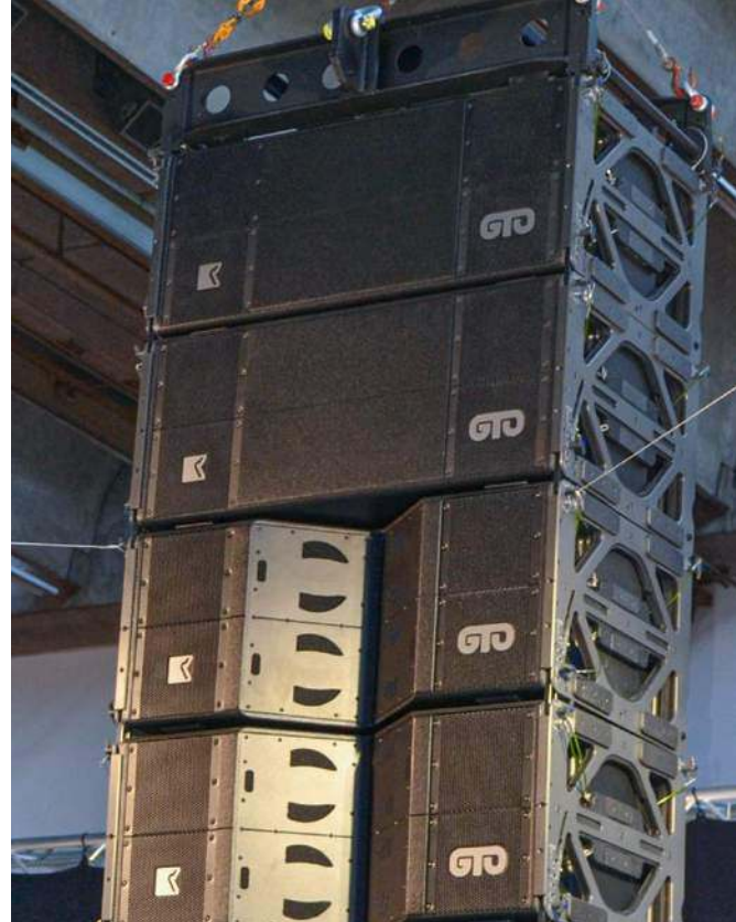
Aby wesprzeć system w zakresie basowym (ale nie subbasowym), wraz z modułami szerokopasmowymi można powiesić moduł rozszerzenia basowego GTO-LOW.
