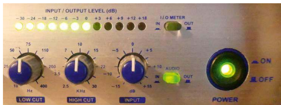
Sygnał szumowy przechodzi przez układ regulowanych filtrów dolno- i górnoprzepustowych.
