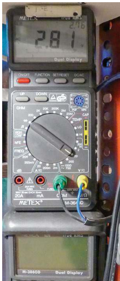
Napięcie odfiltrowanego sygnału szumu różowego kontrolowane jest przez woltomierz true RMS.
