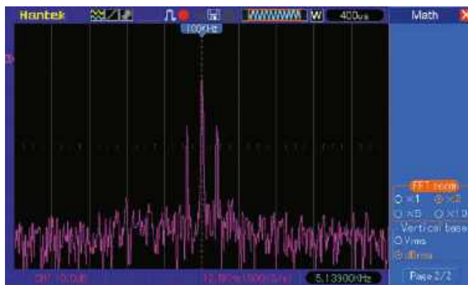
Rysunek 4. Zgodnie z oczekiwaniami, widmo sygnału z rysunku 3 ma jeden wyraźny prążek przy 100 kHz z dwoma mniejszymi prążkami, 5 kHz po obu stronach (tj. przy 95 kHz i 105 kHz)
