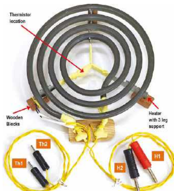
Rysunek 7. Spirala grzejna z trzema nóżkami, mocowanie termistora i przewody w izolacji teflonowej
