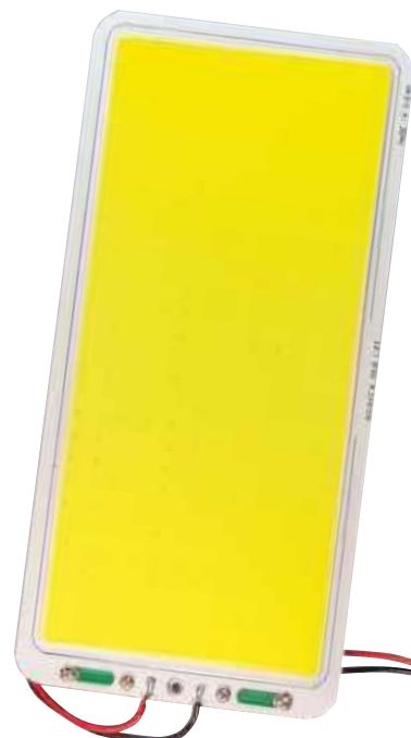
Gdy panel jest wyłączony, można dostrzec liczne małe diody LED, które zapewniają strumień świetlny pod powłoką żelutę fosforową (choć są one trudne do zobaczenia na tym zdjęciu)
