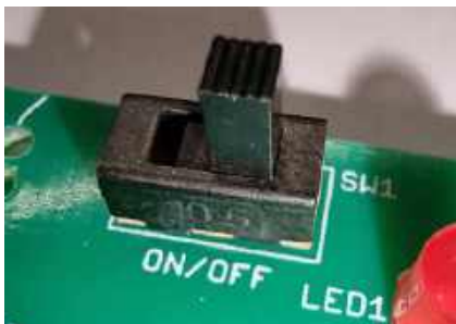
Fotografia 11. Montaż przetłaczniaka umożliwiającego galwaniczne odłączenie baterii od układu elektronicznego
