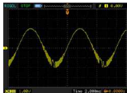
6. Zjawisko wzbudzenia się układu na częstotliwości ok. 1 MHz, pod wpływem pracy z obciążeniem o charakterze reakcyjnym, któremu zapobiega zastosowanie cewki L1 na wyjściu wzmacniacza mocy
