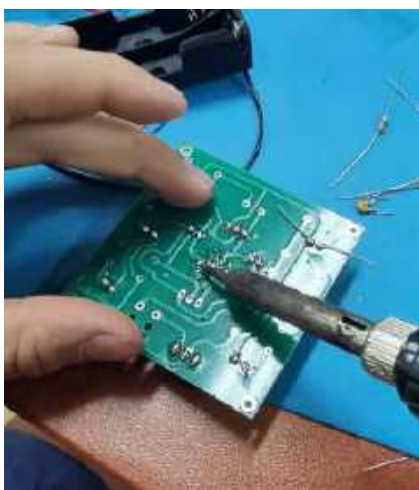
Fotografia 10. Montaż mikrofonu elektretowego może przysporzyć nieco trudności z uwagi na dwa rzędy odmaskowanych pól lutowniczych. Usunięcie zwarcia (mostka lutowniczego) gdy płytka leży płasko na stole nie będzie łatwe. Lepiej trzymać ją prostopadle do stołu, o po dotożeniu świeżej cyny, usunąć jej nadmiar, wspomagając się siłą grawitacji. Trzy pola lutownicze w ramach każdego z tych rzędów są celowo połączone za pomocą ścieżki i nie należy ich separować
