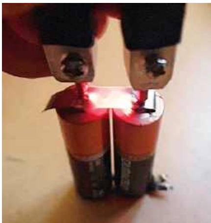
Aby zilustrować użytą energię i potencjalne niebezpieczeństwo, pokazano wynik umieszczenia sond na zakładce między dwoma ogniwami AA. Kondensatory zostały naładowane do 15 V, więc odpowiada to energii około 127 J
