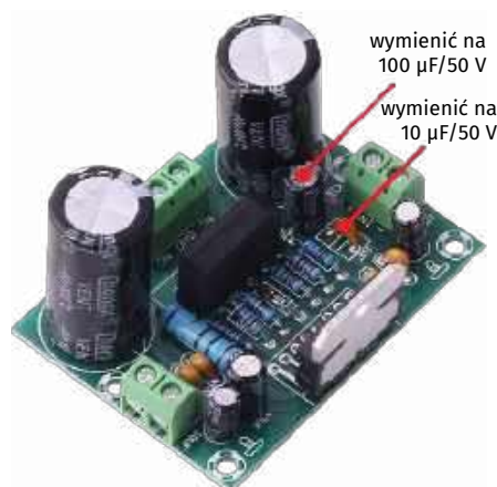
7. Chiński moduł wzmacniacza z układem TDA7293 z oznaczonymi elementami elektronicznymi (kondensatorami), które należy wymienić Źródło: https://allegro.pl
