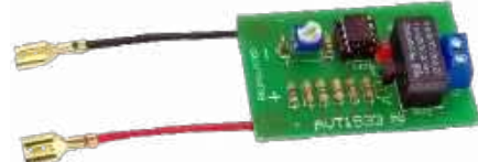
AVT1533 Zabezpieczenie akumulatora 12 V przed rozładowaniem https://sklep.avt.pl/avt1533.html
