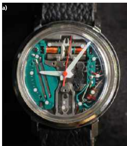
Fotografia 2. Zegarek Bulova Accutron od frontu (a) i tyłu (b). Od frontu widać kamerton i jego cewki napędzające w górnej części zegarka oraz część komponentów obwodu sterującego. Kamerton oscyluje z częstotliwością 360 Hz, dlatego ten zegarek nie „cyka”, a brzęczy
