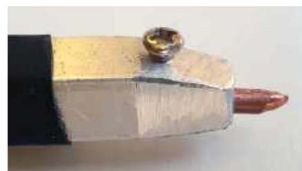
Rysunek 14. Przekrój poprzeczny sond zgrzewających wykonanych z 10 mm kwadratowego pręta aluminiowego. Końcówki zgrzewające to miedziane pręty o średnicy 3 mm zeszlifowane stożkowo do ostrego punktu. Zbliżenie jednej z końcówek pokazano obok tego przekroju
