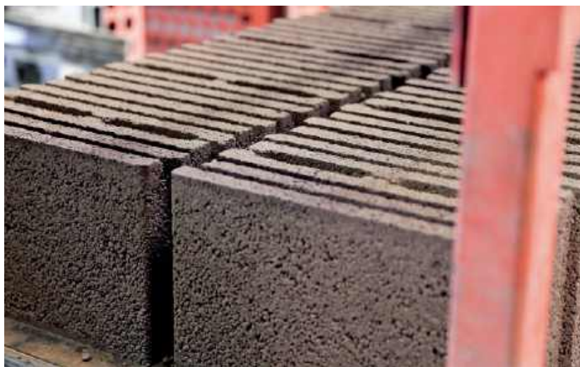
❶ Pustak z keramzytobetonu ma lekko porowatą powierzchnię, co zwiększa przyczepność tynku. CZAMANINEK
