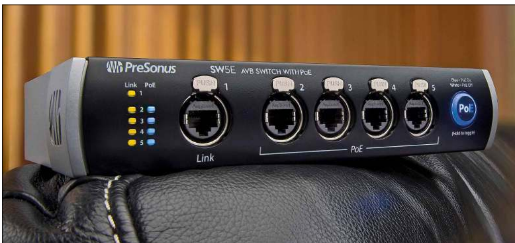
Switch AVB SW5E umożliwia przesyłanie napięcia zasilania przez kabel sieciowy (PoE – Power over Ethernet).
