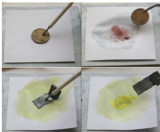
6. Elektrograficzne wykrywanie miedzi (na górze) i ołowiu (na dole),...
