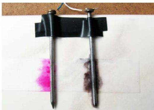
4. Charakterystyczne barwy fenoloftaleiny i jodu w obecności skrobi pozwolą określić znaki biegunów źródła prądu stałego
