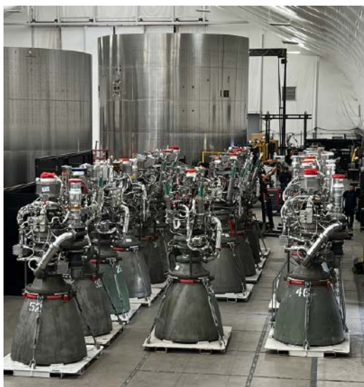
Silniki rakietowe Raptor V2 w zakładzie produkcyjnym SpaceX w Teksasie
