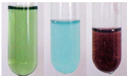
8. Od lewej: roztwór soli miedzi i żelaza, probówka po dodaniu roztworu \text{NaF} , probówka po dodaniu roztworu żelazocyjanku. tym razem brunatny osad potwierdza obecność miedzi w próbce.
