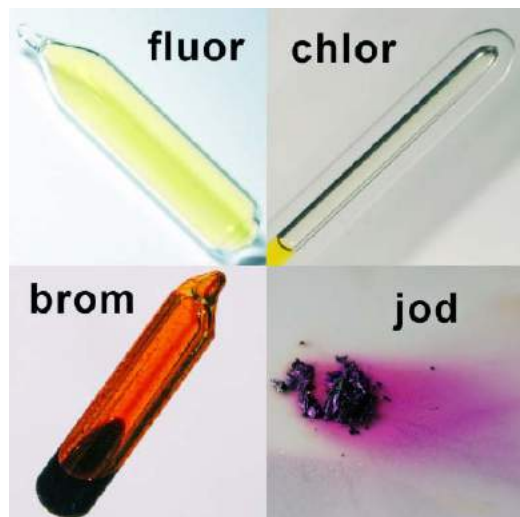
1. Fluorowce – fluor w ampułce pod wysokim ciśnieniem, aby lepiej uwidocznić jego barwę; gazowy chlor znajduje się nad skroplonym (fot. z serwisu http://images-of-elements.com ).
