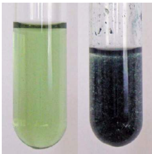
7. Z lewej: roztwór soli miedzi i żelaza. Z prawej: probówka po dodaniu roztworu żelazocyjanku. Nie można stwierdzić obecności jonów miedzi w próbce.
