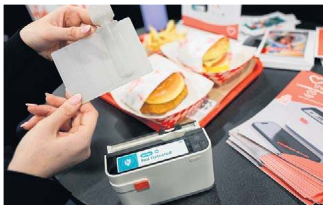
Podręczne urządzenie do badania składu żywności
