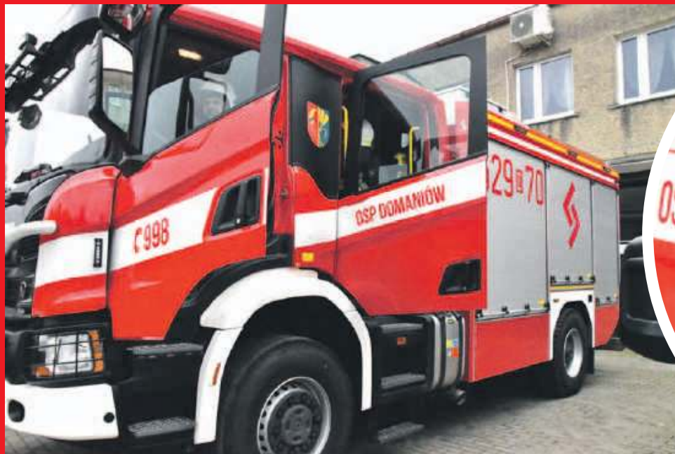
Nowy samochód ratowniczo-gaśniczy to scania ze zbiornikiem na 5000 litrów wody
