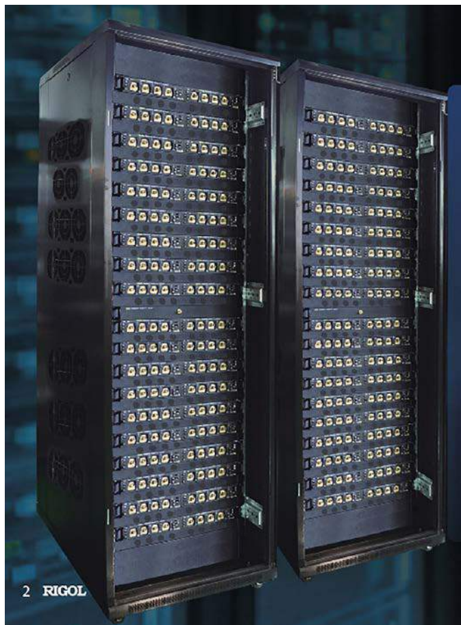
Fotografia 6. Przykład zastosowania oscyloskopów Rigol z serii DS8000-R jako modułów wejściowych superszybkiego systemu akwizycji DAQ
