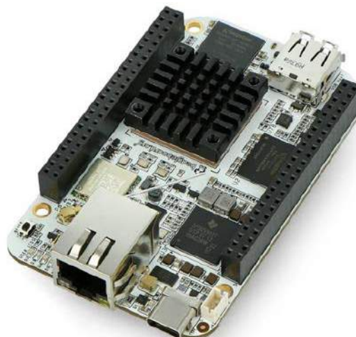
Fotografia 2. Minikomputer BeagleBone AI z procesorem Texas Instruments Sitara AM5729. Algorytmy sztucznej inteligencji mogą być implementowane dzięki bibliotece TIDL udostępnionej przez producenta
