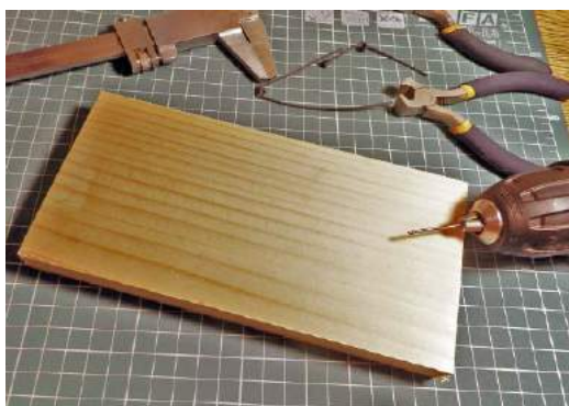
Fotografia 6. Podstawa mechanizmu w niej będziemy wiercić otwory na suporty
