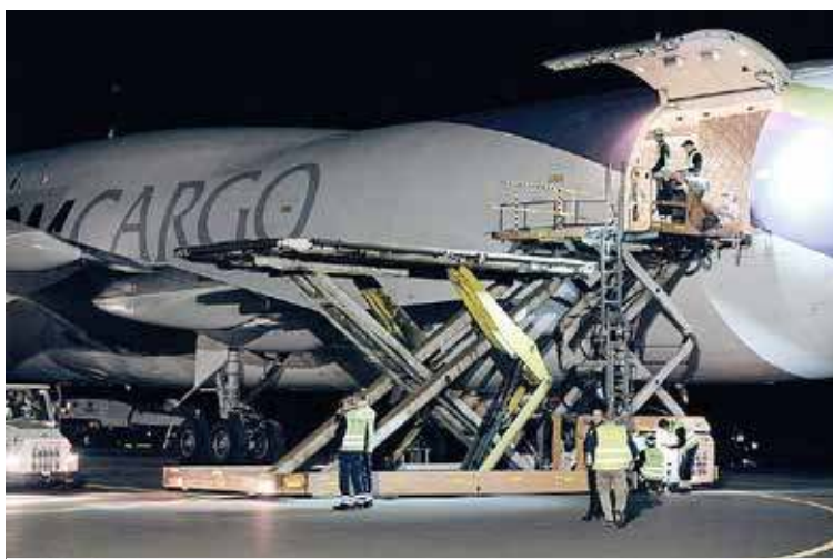
Rozładunek olbrzymiego cargo przy użyciu dźwigu
