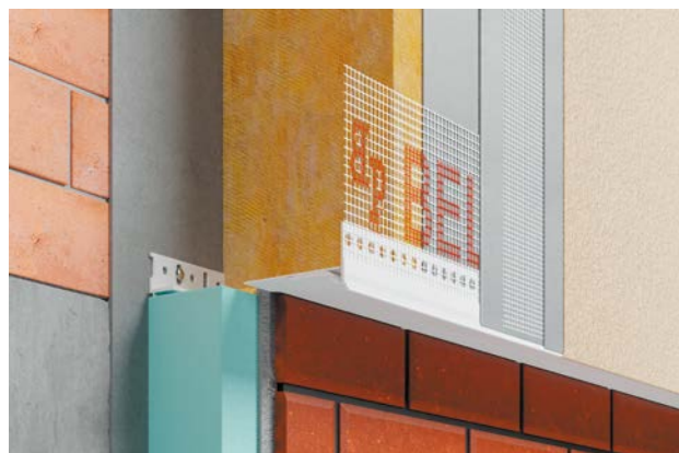
FOT. 1 Listwa startowa okapnikowa z siatką i regulowaną półką
