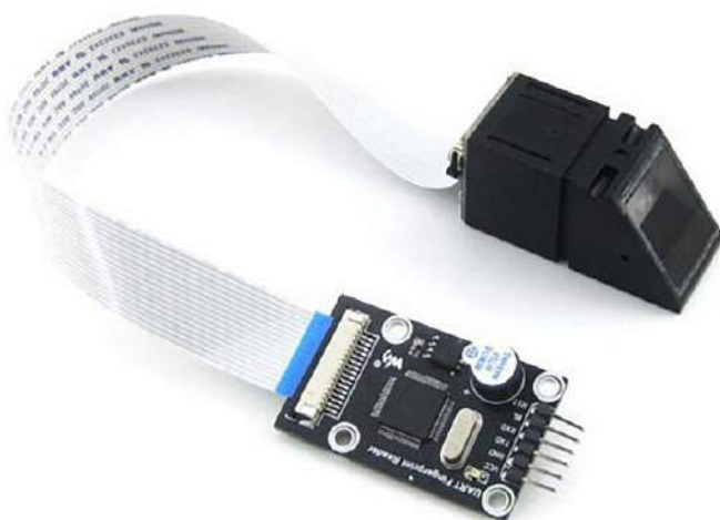
Fotografia 10. Moduł OEM z optycznym czytnikiem linii papilarnych marki Waveshare
