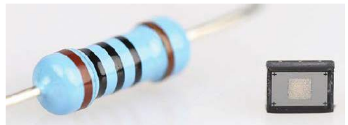
Fotografia 4. Porównanie rozmiaru oświetlacza typu flood illuminator (MERANO PD marki AMS) ze standardowym rezystorem przewlekłym
