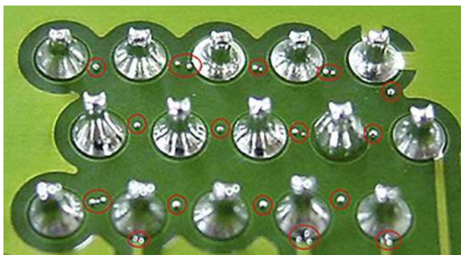
Fotografia 21. Kulkowanie – defekt powstający podczas lutowania z użyciem pasty lutowniczej
