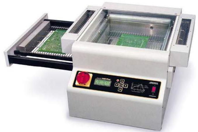
Fotografia 20. Piec lutowniczy do małoseryjnego lutowania rozplwowego
