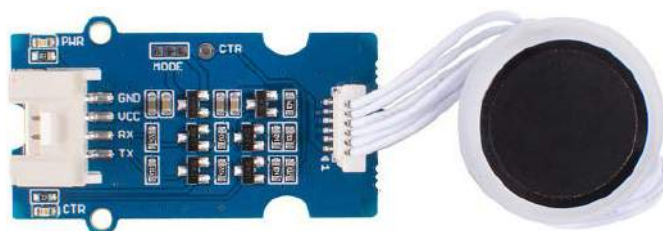
Fotografia 14. Moduł pojemnościowego skanera odcisków palca OEM – rozwiązanie opracowane przez firmę Seedstudio
