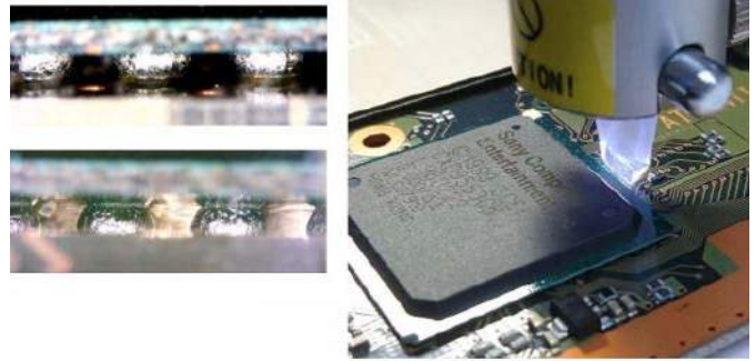
Fotografia 10. Urządzenie do optycznej inspekcji montażu układów BGA
