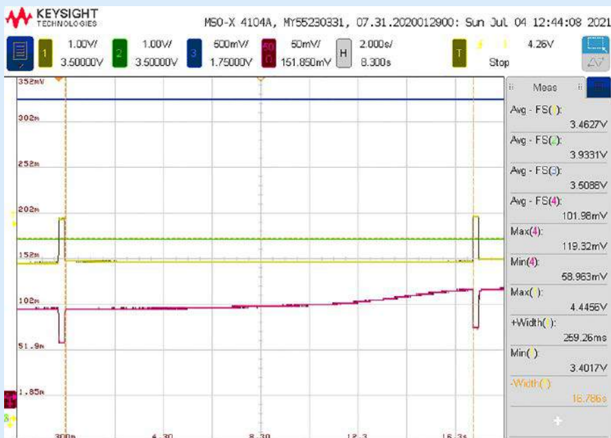
Rysunek 5. Praca modułu CJMCU-2557 z układem BQ25570
