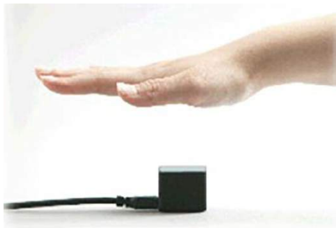
Fotografia 6. Bezdotkowy, biometryczny skaner unaczynienia marki iDentyTech, źródło: https://identytech.com/palm-vein-recognition
