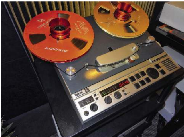
A to już autentyczny majstersztyk z epki magnetofonów (choć nie taki stary, z lat 90.) – Lyrec PTR-1 Frida, ostatnia konstrukcja duńskiej firmy Lyrec. Fantastyczna mechanika i kontrola przesuwu taśmy.
