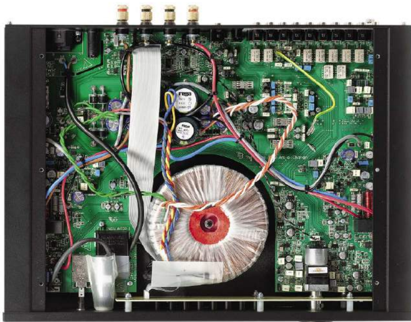
Większość układów osadzono na jednej dużej płytce.
