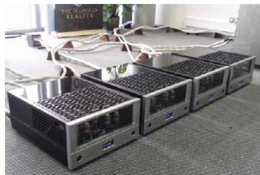
Kolumny Schweikert Audio Ultra 7 podłączono do baterii lampowych końcówek mocy VAC 300 Master-block, zmostkowanych do bi-ampingu. W sumie ponad 1000 W z 32 lamp KT88. Na drugim planie kable na podstawkach – do takiej zabawy chętnie przyłączy się i dziecko.
