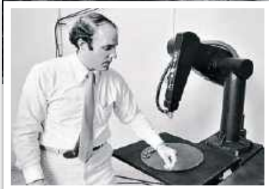
To był dopiero początek: po Unimate pojawiły się kolejne, coraz lepsze roboty. Na przykład ramię sterujące o nazwie PUMA.
