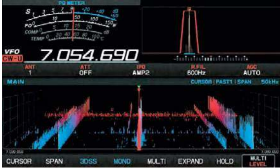
Trójwymiarowy wskaźnik zmian widma w funkcji czasu. Na przodzie wyświetlana jest sytuacja bieżąca
