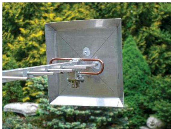
Rys. 2. Sposób wykonania baluna (transformatora) na pasmo 23 cm
