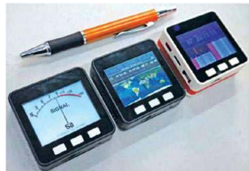
Fot. 3. Niektóre projekty oparte na mikrokomputerze M5Stack. Od lewej do prawej: miernik siły sygnału dla IC-705, wyświetlacz informacji DX-owych i pulpit informacyjny sieci RRF
