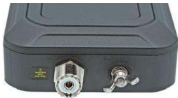
Po drugiej stronie obudowy znajduje się gniazdko koncentryczne do podłączenia anteny i zacisk uziemienia
