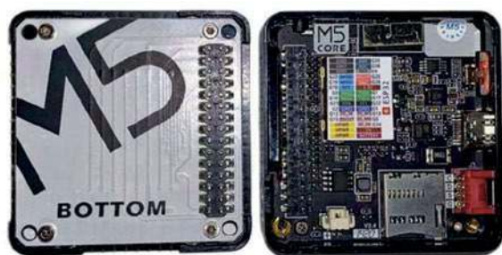
Fot. 1. Główny moduł serii M5Stack – denko i widok wnętrza
