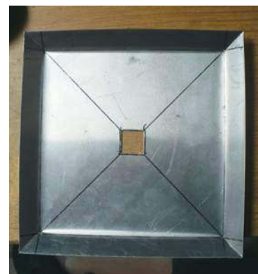
Rys. 1. Sposób wykonania wibratora (R) na pasmo 23 cm
