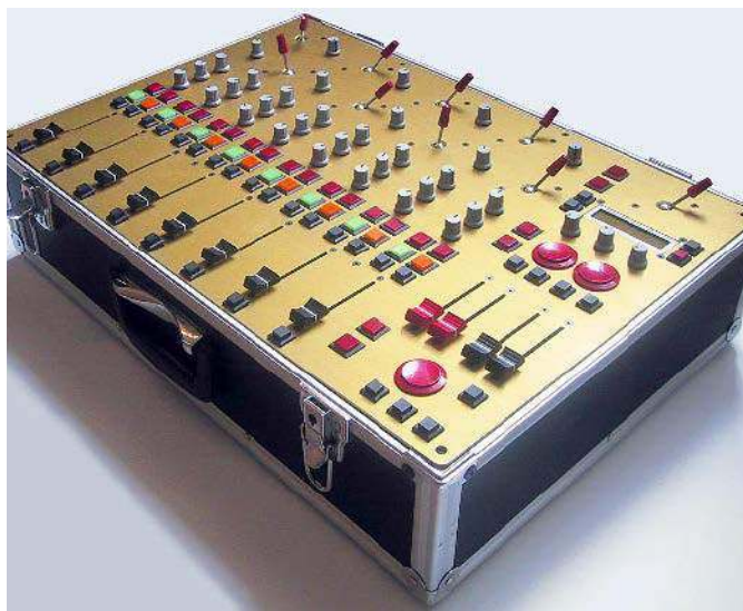
Fotografia 4. Kontroler MIDI na bazie MIDIBox64 wykonany przez Patricka
