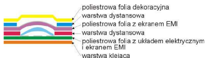
Rysunek 4. Przekrój klawiatury z ekranem EMI/RFI
