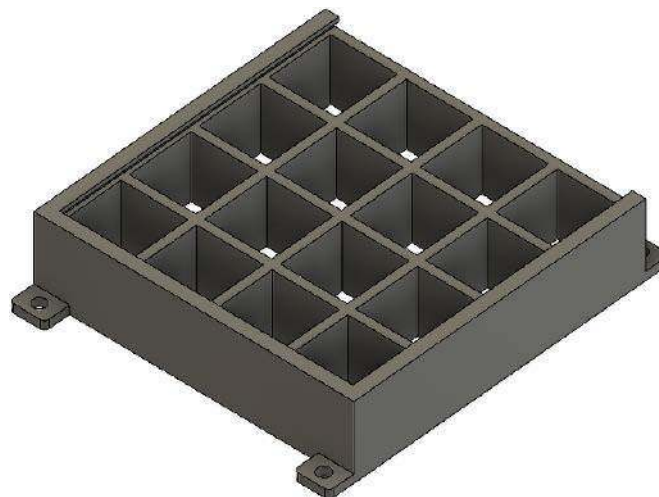
Rysunek 10. Model 3D panelu „przegródek”
