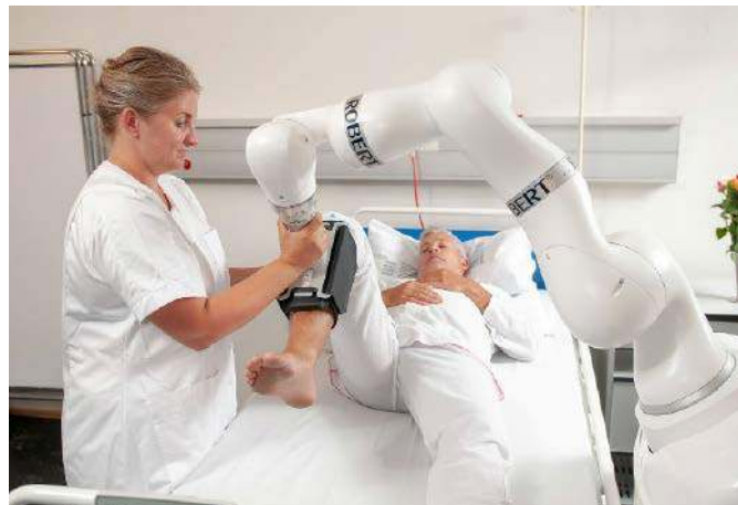
Fotografia 29. Ramię robota KUKA LBR Med, zastosowane do prowadzenia rehabilitacji ( https://t.ly/7fxLS )
