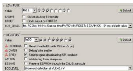
Rysunek 4. Szczegóły ustawienia bitów zabezpieczających
