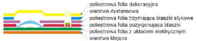
Rysunek 3. Przekrój klawiatury z blaszkami i diodami SMD
