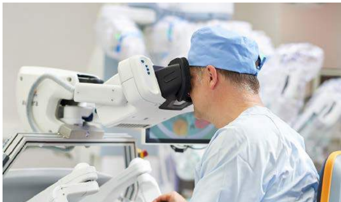
Fotografia 10. Smukła konstrukcja konsoli operatorskiej robota awatera umożliwia bezproblemową komunikację głosową chirurga z personelem, znajdującym się w sali operacyjnej ( https://t.ly/5Nmm6 )
