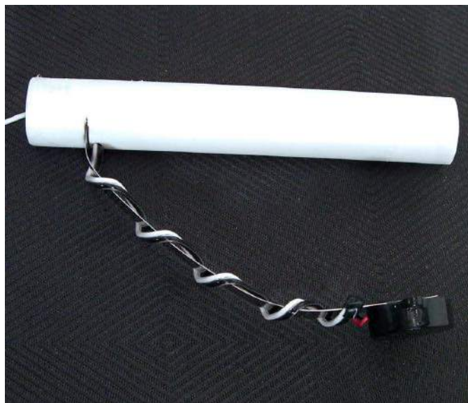
Fotografia 3. Detektor zainstalowany na sprężynie dociskowej
