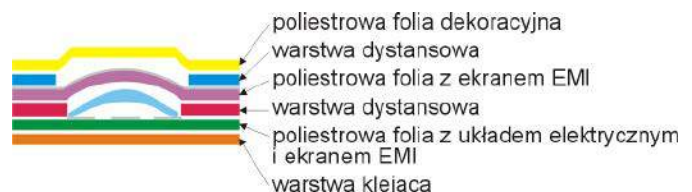
Rysunek 4. Przekrój klawiatury z ekranem EMI/RFI
