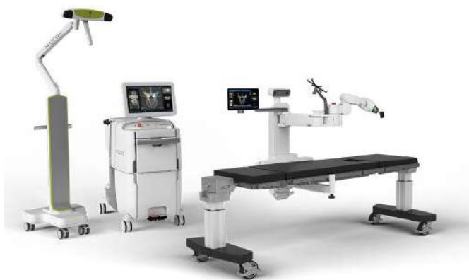
Fotografia 18. System Mazor marki Medtronic, przeznaczony do wspomagania operacji kręgosłupa ( https://t.ly/sMPM1 )
