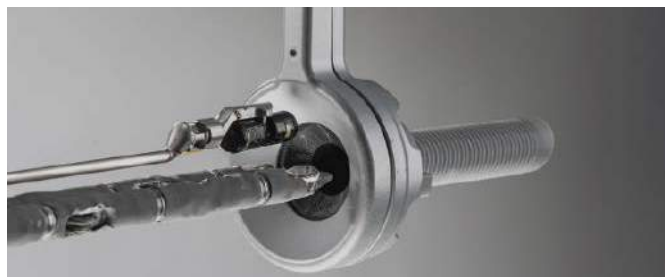
Fotografia 7. Narzędzia robota chirurgicznego marki Vicarious Surgical w stanie umożliwiającym wsunięcie ich do portu laparoskopowego ( https://t.ly/uMISW )
