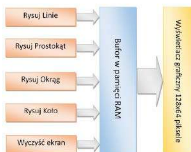
Rysunek 10. Koncepcja działania interfejsu graficznego obsługującego wyświetlacz LCD
