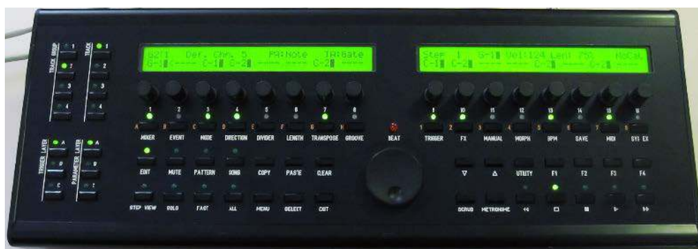
Fotografia 2. Sekwencer MIDIBox SEQ V4
