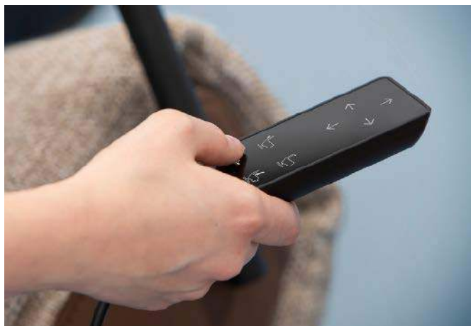
Fotografia 8. Wysokiej klasy sterownik fotela bazujący na klawiaturze dotykowej marki Schurter
