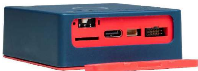
Rysunek 5. Rozmieszczenie złączy Nordic Thingy:53 [3]
