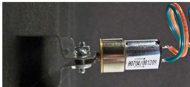
Fotografia 2. Uchwyt zamka zamontowany do osi silnika
