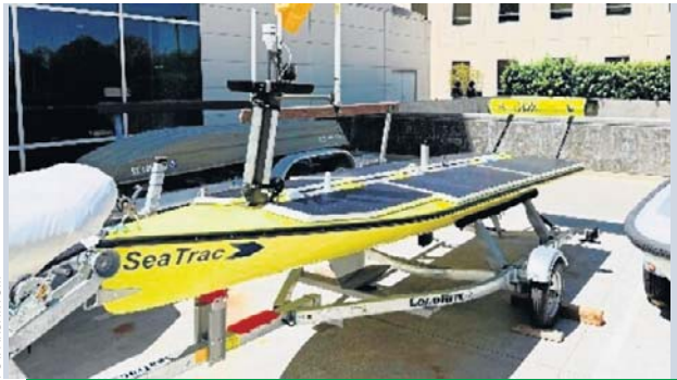
Półautonomiczny robot do monitorowania rekinów
