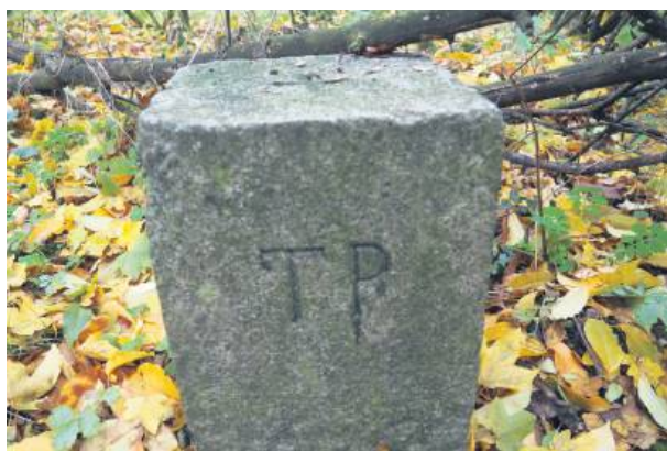
Punkt geodezyjny na szczycie wzgórza
