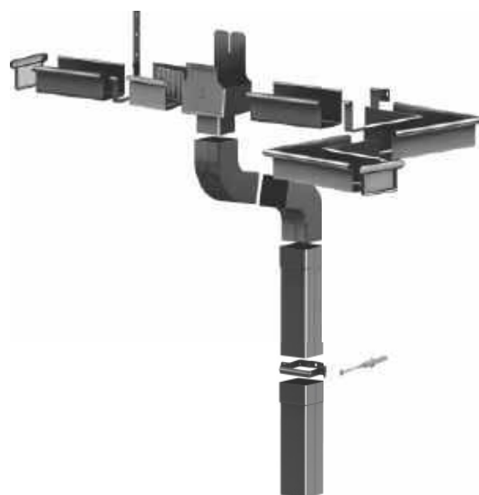
System rynnowy o przekroju kwadratu. BLACHY PRUSZYŃSKI, FOLIAREX
