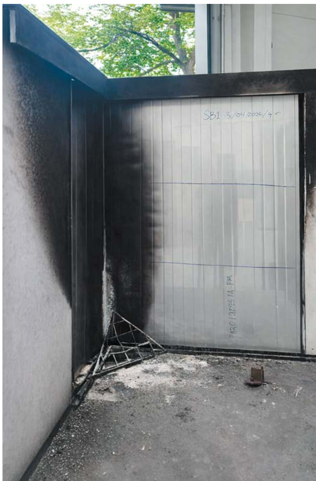
FOT. 1 Płyta warstwowa PIR po badaniu SBI
