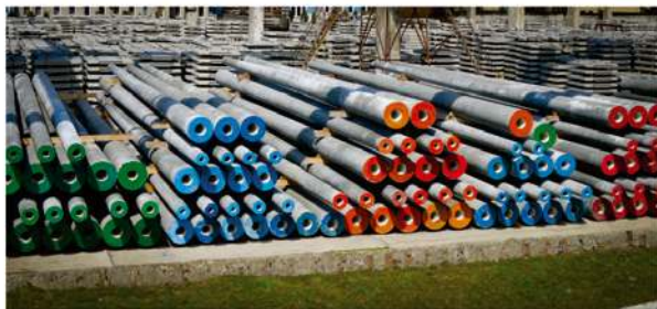
ZAKŁAD BETONÓW W KOLBUSZOWEJ - ŻERDZIE WIROWANE
