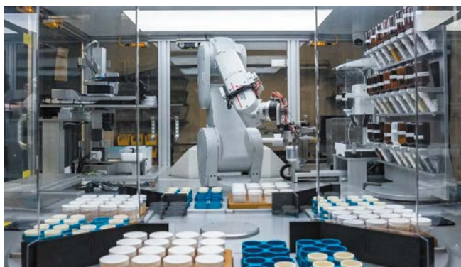
FOT. 1 Autonomiczne laboratorium A-Lab w Lawrence Berkeley National Laboratory, w którym sztuczna inteligencja kieruje pracą robotów w celu syntezy nowych materiałów; fot.: Google DeepMind
