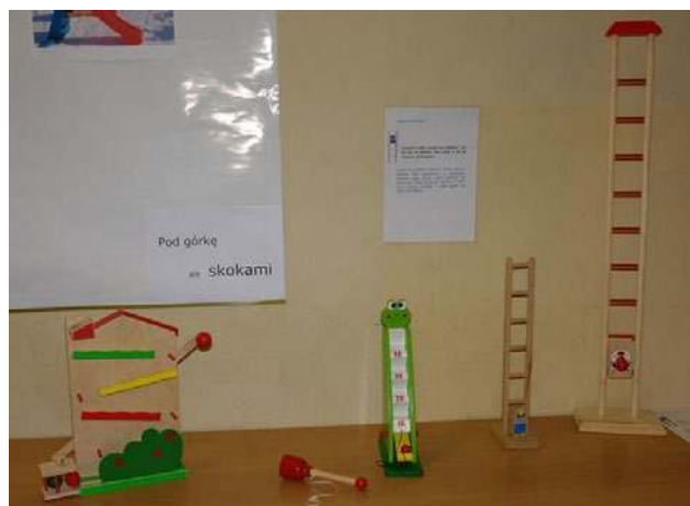
Ryc. 8. Dwa komplementarne stoły w temacie przemian energii mechanicznej. (a) Podnosząc kulkę do wysokości daszku karmnika dostarczamy energii potencjalnej. Krok po kroku ta energia zamienia się w ruch poszczególnych ptaszków. Po prawej stronie ekspozycji „Popchnij mnie!” – klocek na równi tak pochyłonej, aby zsuwał się dopiero po popchnięciu, dla ilustracji różnicy między współczynnikiem tarcia statycznego i dynamicznego. (b) Dwie drabinki z „kominarzami” – idea podobna do „karmnika ptaszków” oraz żaba-wrzutka, ilustrująca przelicznik energii kinetycznej na potencjalną. Ekspozycja po lewej, z Paryża, to dźwignia-wrzutka kulki do wielopoziomowej zjeżdżalni, ekspozycja w środku – gra z Japonii. Idea, ekspozycje, opisy GK, realizacja ZDF UMK 2007.
