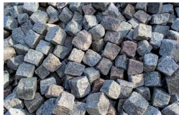
Kostka granitowa z rozbiórki ul. Wolności będzie wykorzystana w innej gminnej inwestycji
