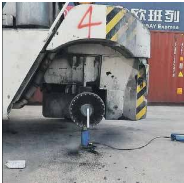
Po odkręceniu większości śrub mocujących koło do bębna osi nastąpiło urwanie elementów metalowych. Siła wyrzutu była tak duża, że spowodowała rozrzucenie części układu na odległość 40-60 metrów
